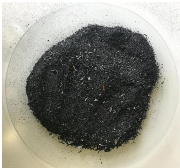
Figura 5 – Cinza da casca de arroz proveniente da empresa Coradini Alimentos localizada em Bagé utilizada no presente trabalho.
