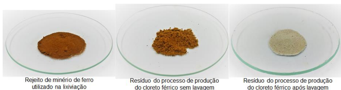
Figura 63 - Comparativo dos resíduos do processo de obtenção de cloreto férrico com o rejeito de minério de ferro
