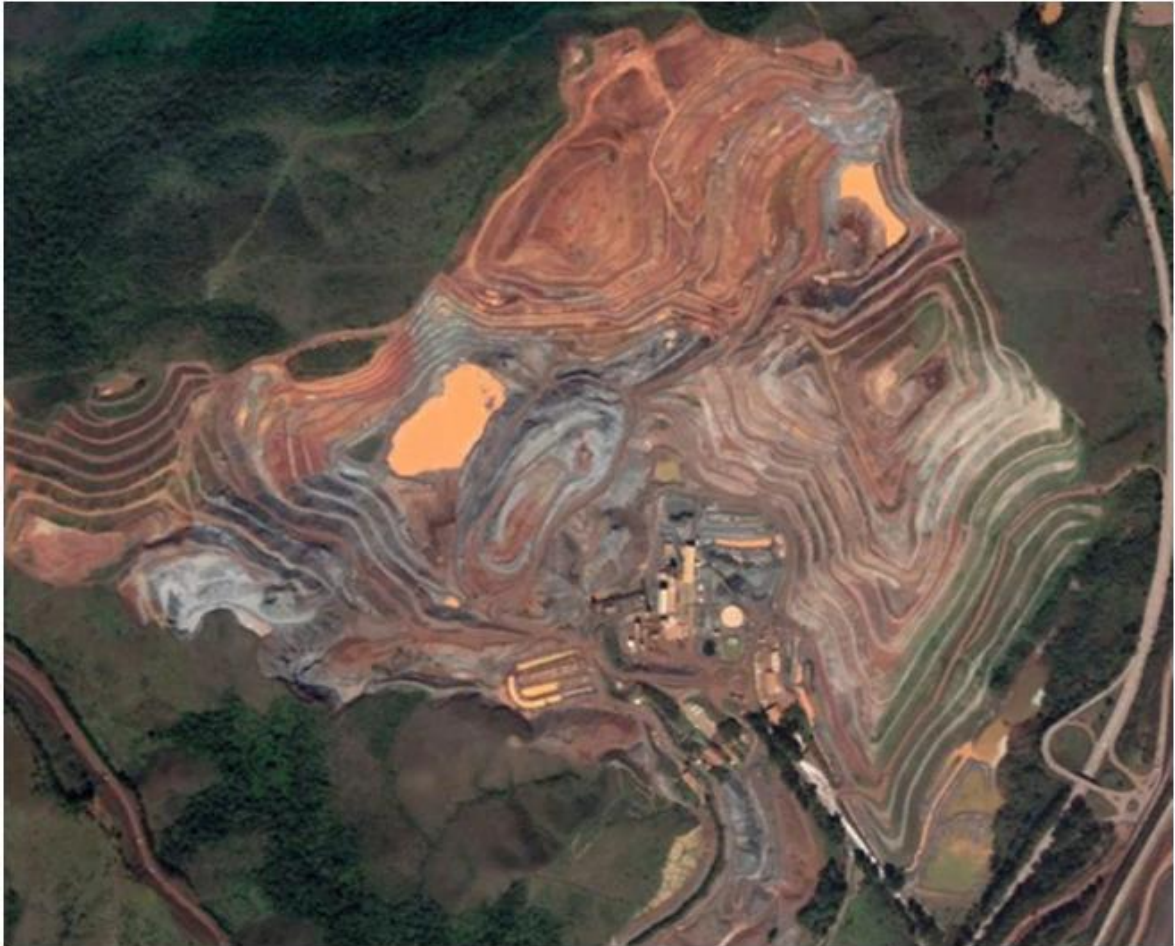
Figura 35 - Lavra de minério de ferro em bancadas.
