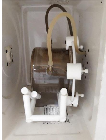
Figura 3: Tambor de torrefação no interior da cavidade de micro-ondas
