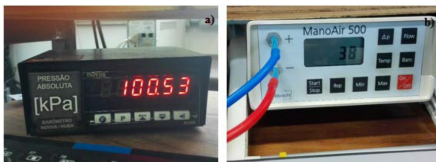
Figura 3.17 – a) Barômetro Novus/Huba N1500; b) Micromanômetro ManoAir 500 (Fonte: INESTROZA, 2017)
