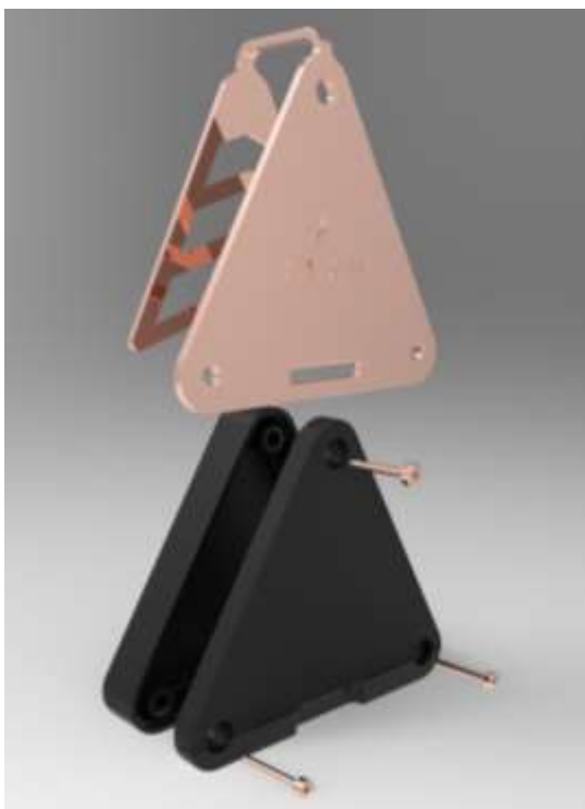
Figura 22 - Perspectiva explodida da carenagem
