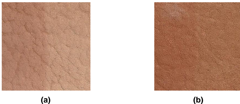
Figura 46 Resultados curtimento couro piquelado (a) Controle tanino (b) SGRS3_T
