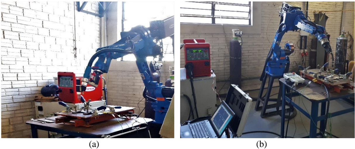
Figura 4.2 - Equipamento de soldagem TIG (a); Equipamento de soldagem MAG (b).
