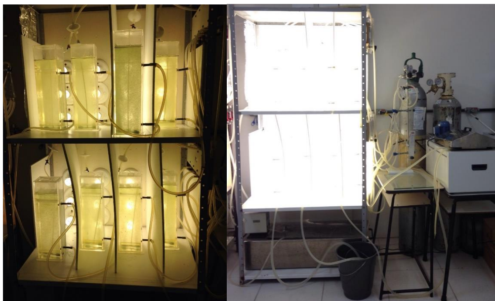
Figura 4.3 – Sistema de fotobiorreatores de placa air lift para cultivos de P. marina .
