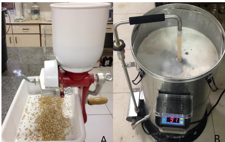
Figura 4.5 – Moagem do malte (a) e produção do mosto no equipamento Grain Father (b).
