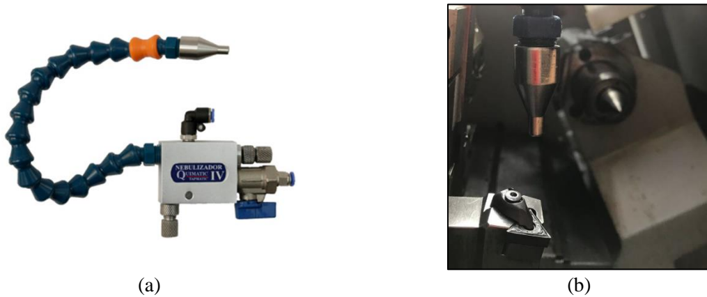
Figura 3.6 – Sistema de lubrificação: (a) aspersor Quimatic IV; (b) posição do bico.
