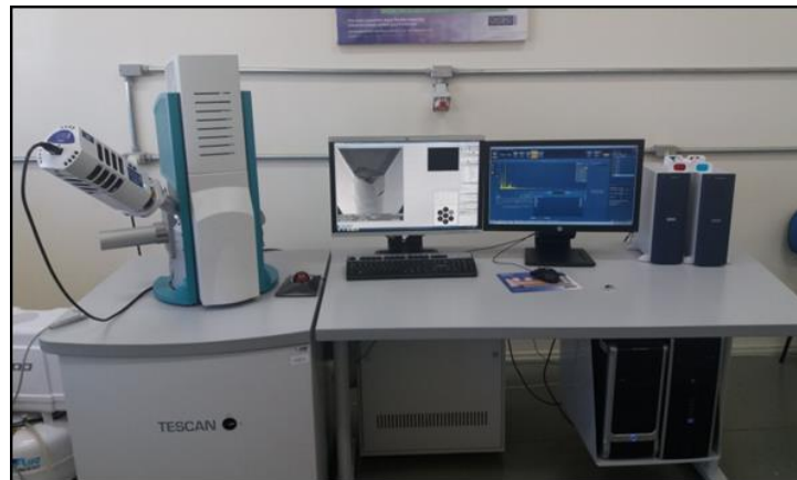
Figura 3.10 – Microscópio eletrônico de varredura e espectrômetro de energia dispersiva.
