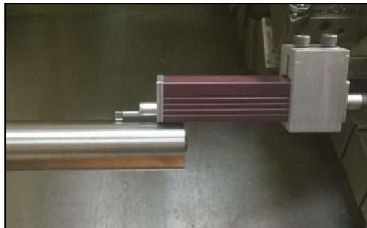
Figura 3.9 – Rugosímetro portátil para a medição da rugosidade.
