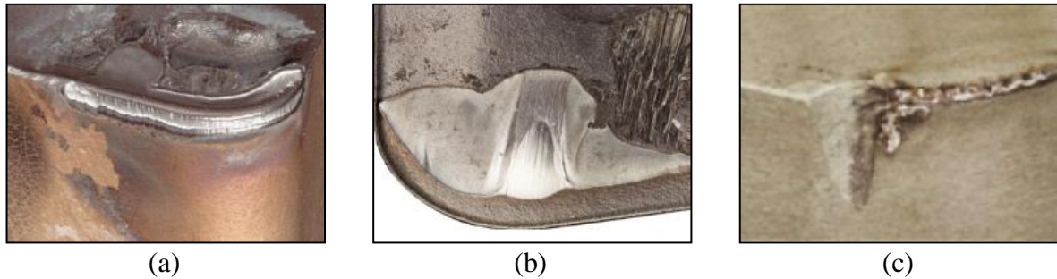
Figura 2.8 – Tipos de desgaste da ferramenta de corte: (a) desgaste de flanco; (b) desgaste de cratera; (c) desgaste de entalhe [Sandvik, 2017].
