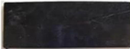
**Figura 1:** Placa de compósito Lam 35 injetada, a partir da qual foram preparados os corpos de prova desta formulação. A placa original apresenta dimensões de 250 mm x 100 mm x 6 mm.
