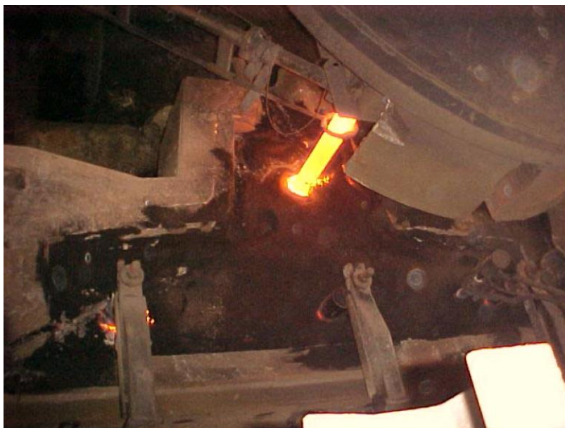
Figura 3.2 Escória de distribuidor com adição de casca de arroz durante a operação do lingotamento contínuo.
