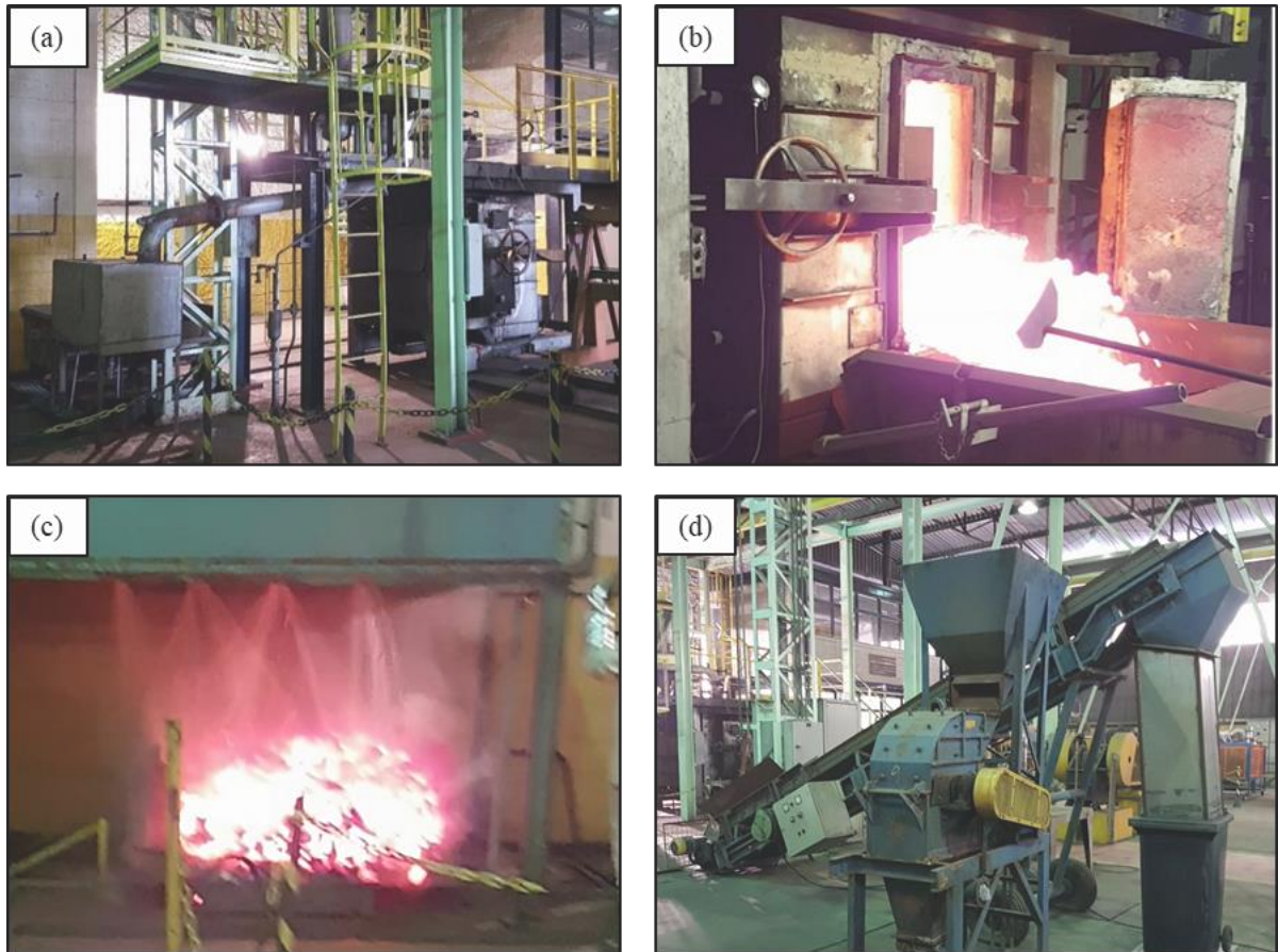
Figura 18 - (a) Forno de coqueificação planta piloto Usina Gerdau Ouro Branco, (b) denformamento do coque, (c) extinção a úmido do coque e (d) aparato de estabilização do coque.
