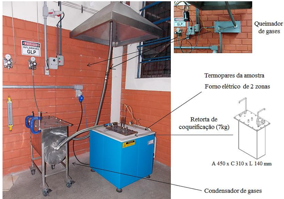
Figura 17 - Aparato laboratorial de coqueificação do LaSid.
