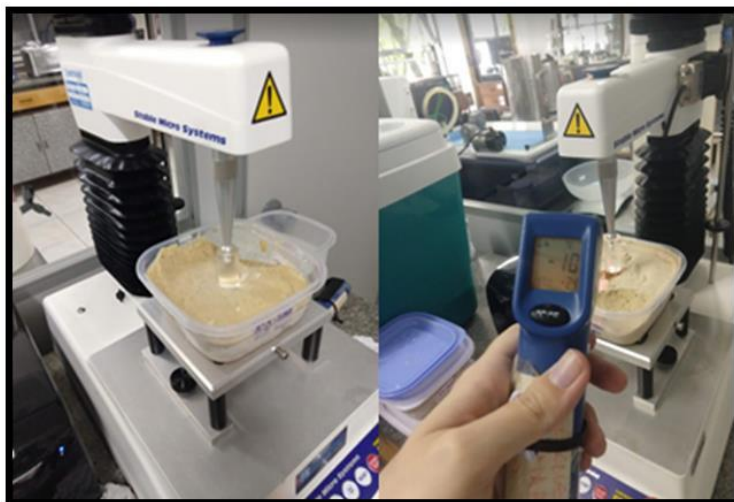
Figura 13: Temperatura controlada no momento da perfuração pelo texturomêtro.
