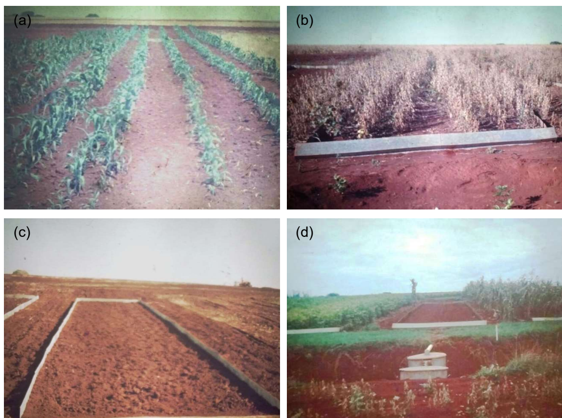
Figura 3: Vista de algumas parcelas experimentais de campo; (a) com milho em estágio inicial em preparo convencional; (b) parcela com soja em estágio final em preparo convencional; (c), parcela padrão (solo descoberto); e, (d) visão geral das parcelas com destaque ao sistema coletor de escoamento. (Fotos: Prof. Elomar Antonino Cassol).
