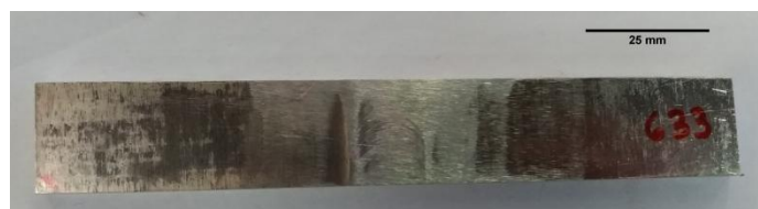
Figura 14 - Geometria dos corpos de prova para o Ensaio de Dobramento.
