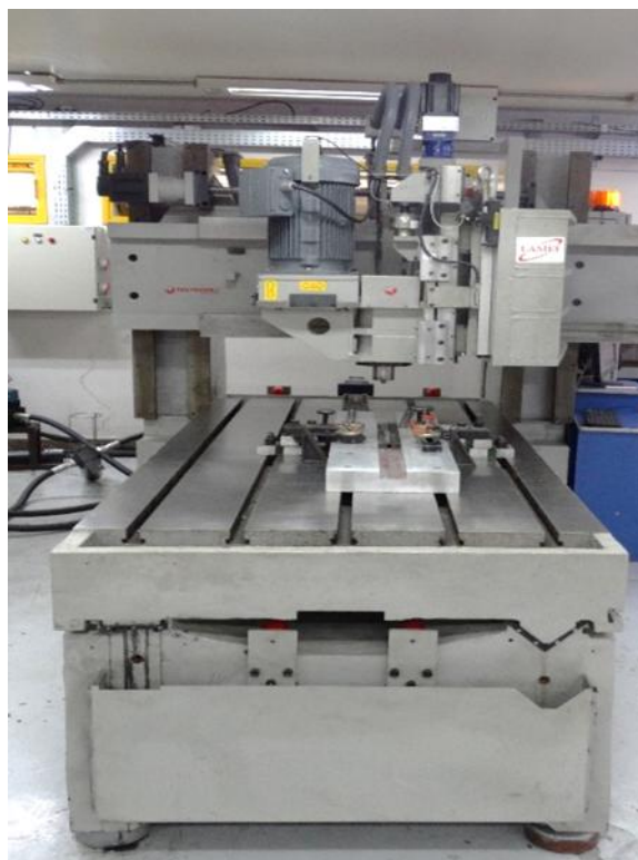
Figura 11 - Máquina de soldagem FSW utilizada para realização das soldas.
