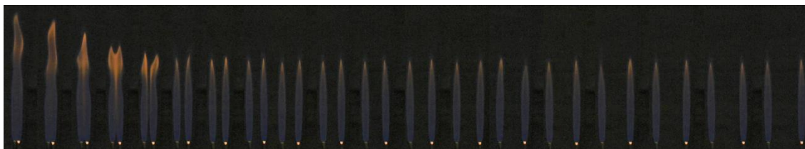
Figura 4.18 – Efeito da diluição de \text{CO}_2 na geometria de chama com o aumento da distância de separação da esquerda para a direita. Vazão de 1 L/min com 50% de \text{CO}_2 .
