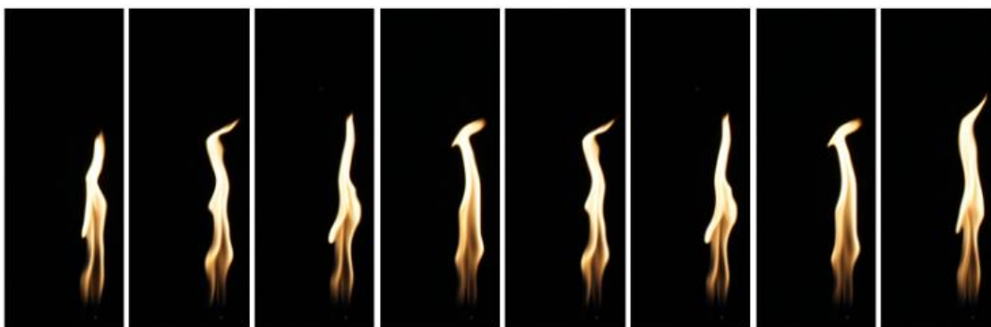
Figura 4.3 – Regime imerso varicoso. Vazão de 1 L/min com 0% de CO 2 na mistura em 7 diâmetros de separação.
