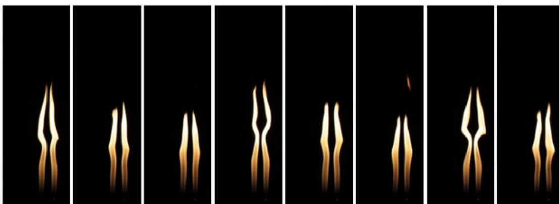
Figura 4.4 – Regime simétrico sinuoso. Vazão de 1 L/min com 0% de CO 2 na mistura em 11 diâmetros de separação.
