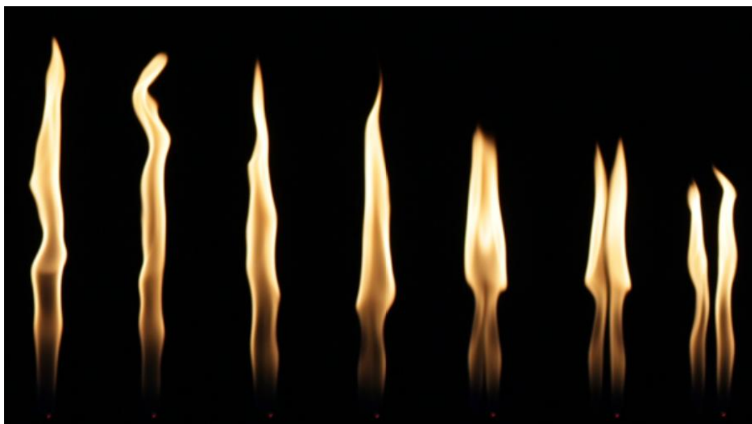
Figura 4.31 – Intensidade luminosa para distância de separação crescente da esquerda para direita. Dados para 1 L/min com 10% de \text{CO}_2 .
