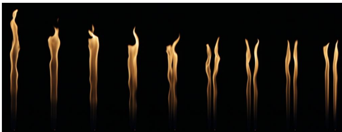
Figura 4.33 – Intensidade luminosa para distância de separação crescente da esquerda para direita. Dados para 2 L/min com 30% de CO 2 .
