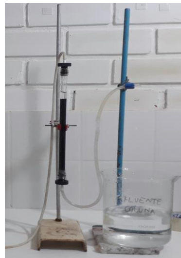
Figura 4.4 - Representação esquemática e fotografia da coluna de escala reduzida.
