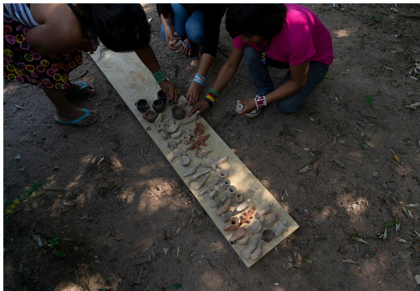
Após o polimento, as peças são colocadas para secar ao sol ou à sombra.
