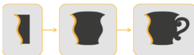
Figura 64: Esquema Ilustrado dos parâmetros de uma geratriz
