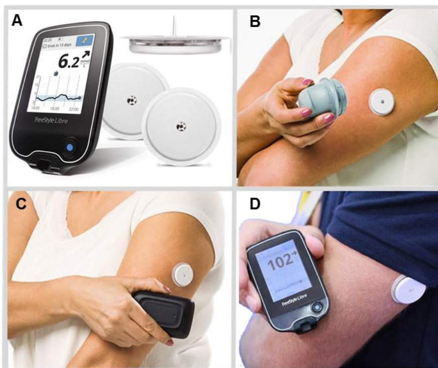
Figura 1: Sistema de monitoramento de glicose intersticial. (A) Sensor e aparelho de leitura da glicose; (B) aplicação do sensor com dispositivo específico do sistema; (C) leitura da glicose – passagem do leitor sobre o sensor; (D) glicemia medida do paciente.
