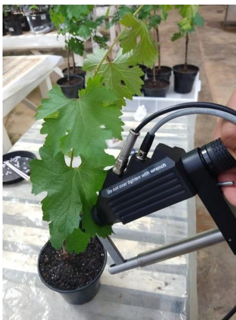
Figura 1. Avaliação espectral com o espectrorradiômetro Field Spec® 3 ASD em folhas de videiras utilizando o acessório ProbeLeaf Clip .
