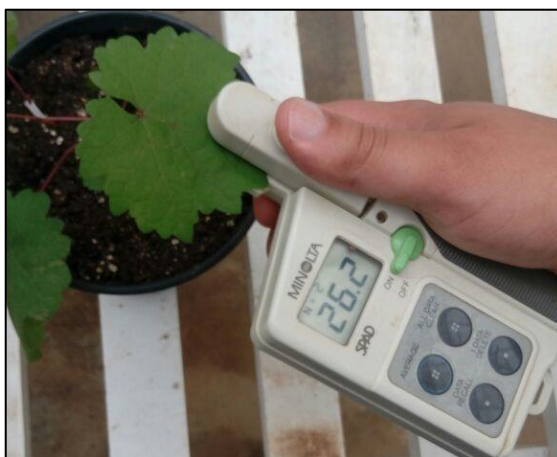
Figura 3. Obtenção do valor relativo de clorofila em folha de videira utilizando o clorofilômetro modelo SPAD-502.
