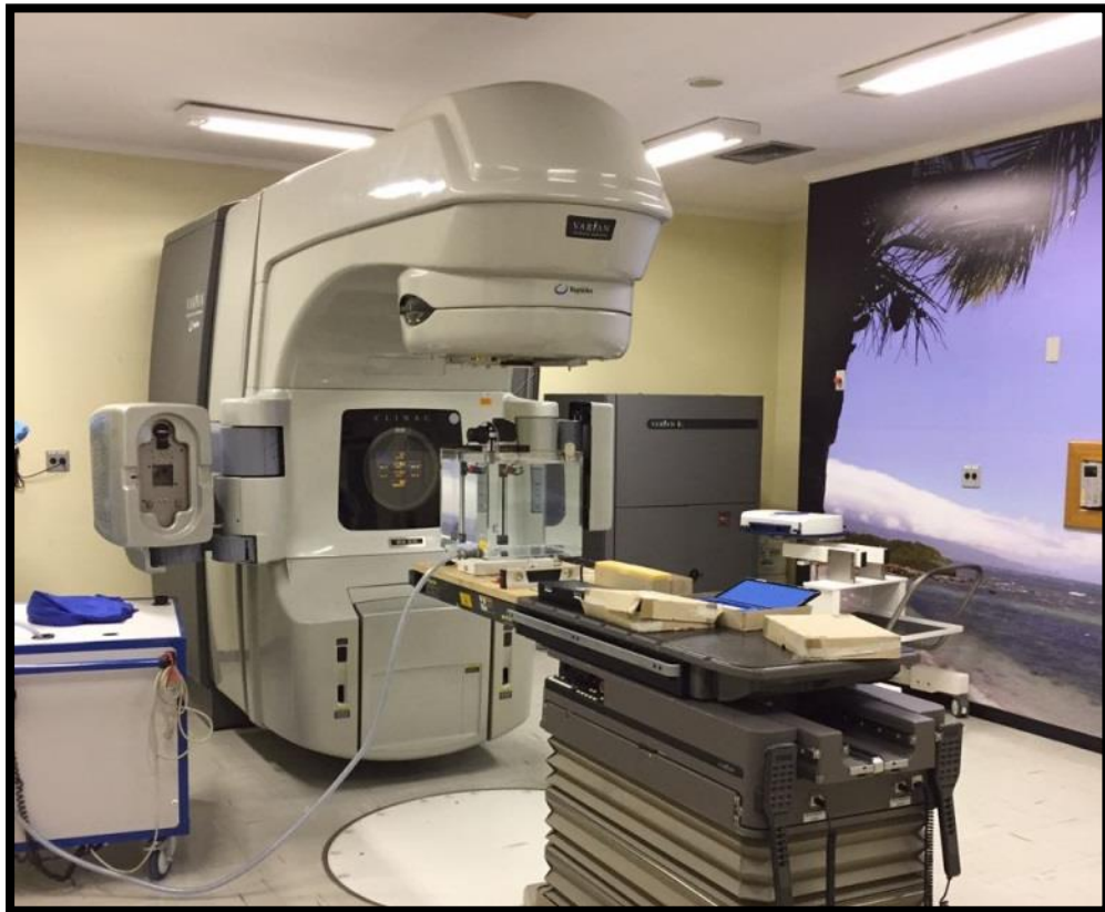
Figura 1: AL instalado no Hospital de Clínicas de Porto Alegre. À esquerda pode-se ver o tanque de água que abastece o phantom (visto ao centro, sobre a mesa de tratamentos).
