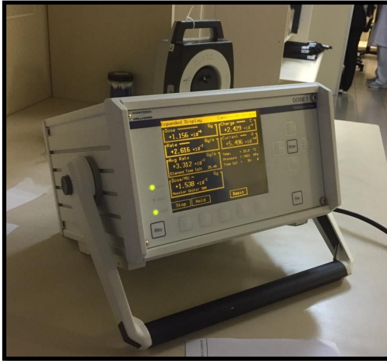
Figura 2: Eletrômetro IBA Scanditronix Wellhöfer , modelo Dose 1 . Eletrômetro que permite a leitura da coleta de carga com até três casas decimais de precisão.
