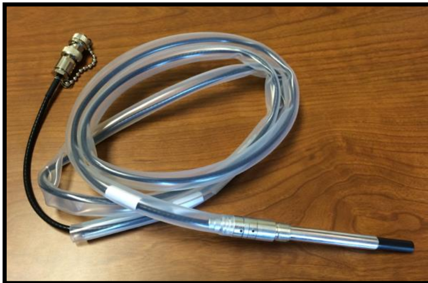
Figura 3: Câmara de ionização cilíndrica tipo Farmer com volume de 0,65 \text{ cm}^3 , fabricante IBA Scanditronix Wellhöfer , modelo FC65-P/TNC (fonte da imagem: grayden.info ).
