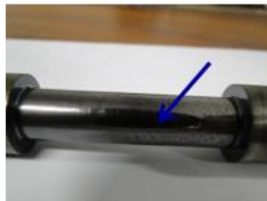
Figura 34 - Região de análise do desgaste dos pinos
