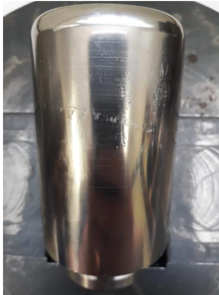
Figura 28 - Punção danificado no ensaio Swift sem lubrificação
