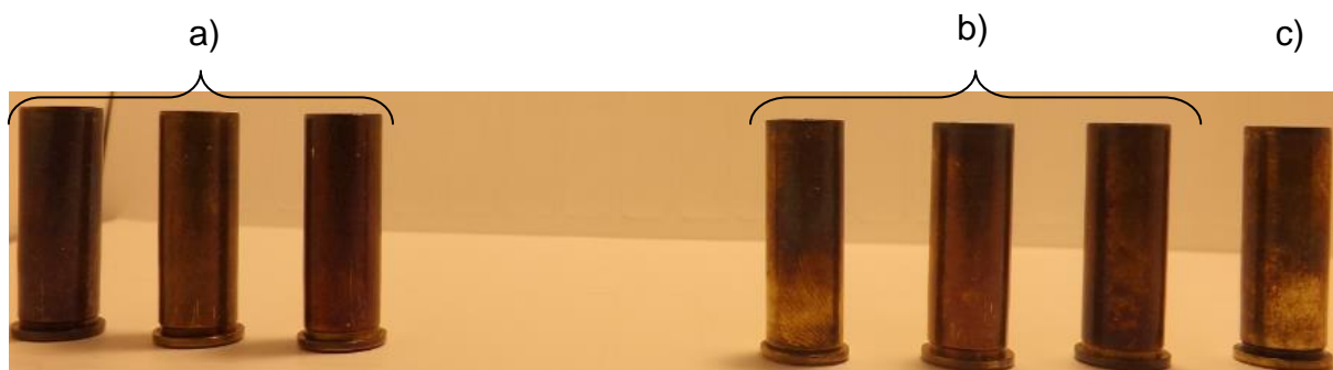
Figura 14 - Estojos de latão limpos após deflagração e revelados:
