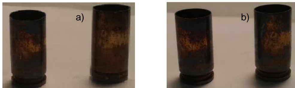
Figura 19 - Remoção do excesso de Gun Blueing e posterior ataque ao estojo de latão com solução reveladora própria para tal:
