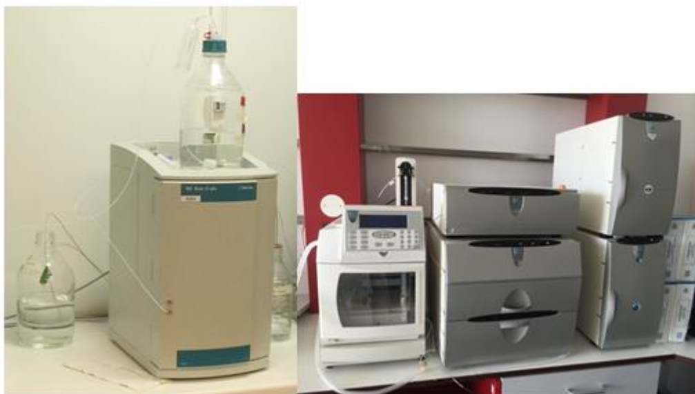
Figura 24 - Sistema do Cromatógrafo de íons marca Metrohm modelo 883 e marca Dionex ICS 3000
