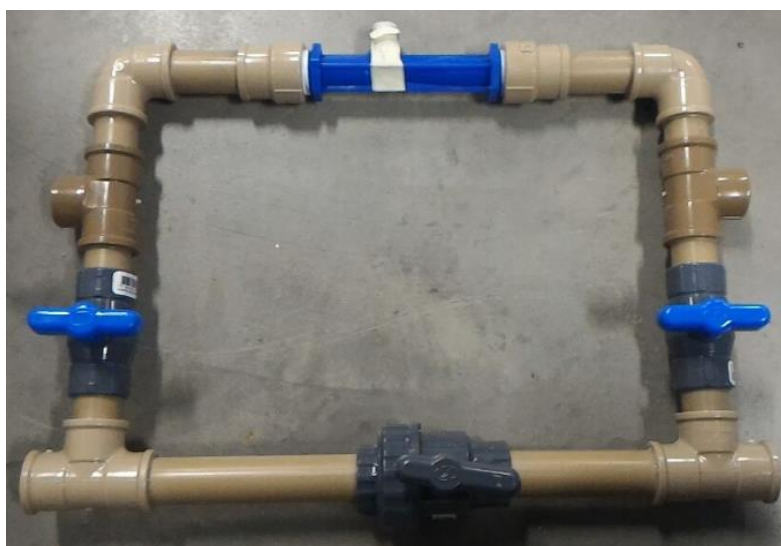
Figura 28 - By-pass com Venturi, registros e duas tomadas de pressão.
