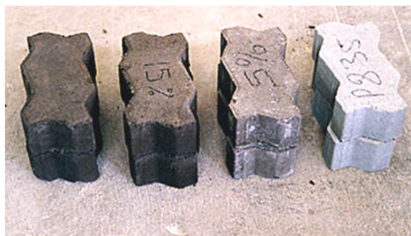
Figura 28 Aspecto dos blocos de concreto com idade de 5 dias. Da esquerda para direita: 25%, 15%, 5% de adição do PAE em relação à massa de cimento e os referência (0%).
