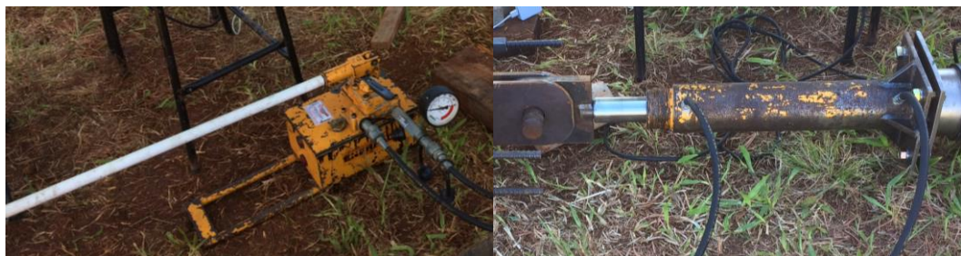
Figura 48 – Cilindro hidráulico e bomba de acionamento de dupla ação
