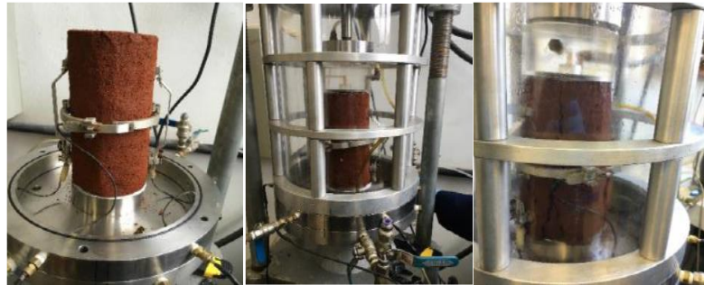
Figura 62 – Ensaio de Compressão simples instrumentado (a) corpo de prova instrumentado (b) durante o ensaio (c) corpo de prova deformado após ruptura (CARRETTA, 2018)
