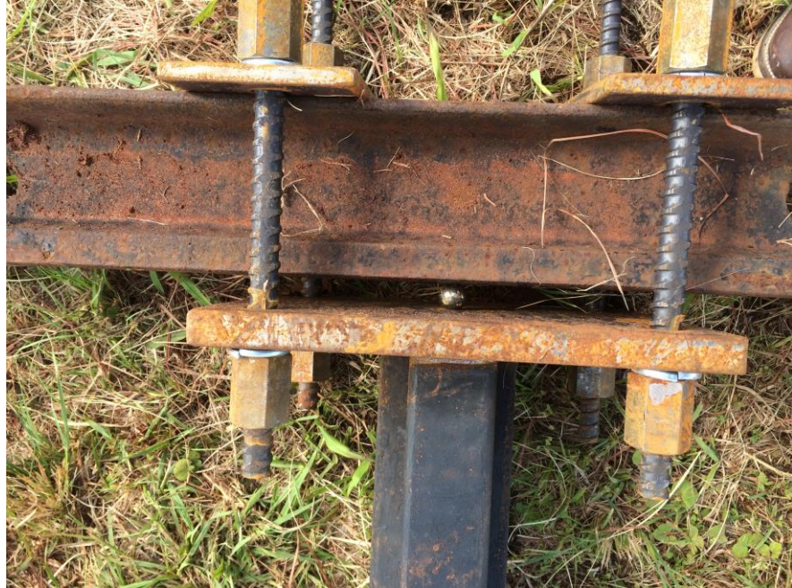
Figura 47 – Esfera na ligação entre sistema de reação e sistema de aplicação de carga
