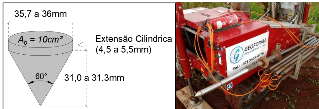
Figura 69 – Cone Padrão ASTM D5778-12 (2012). Imagem em Faro (2014).
