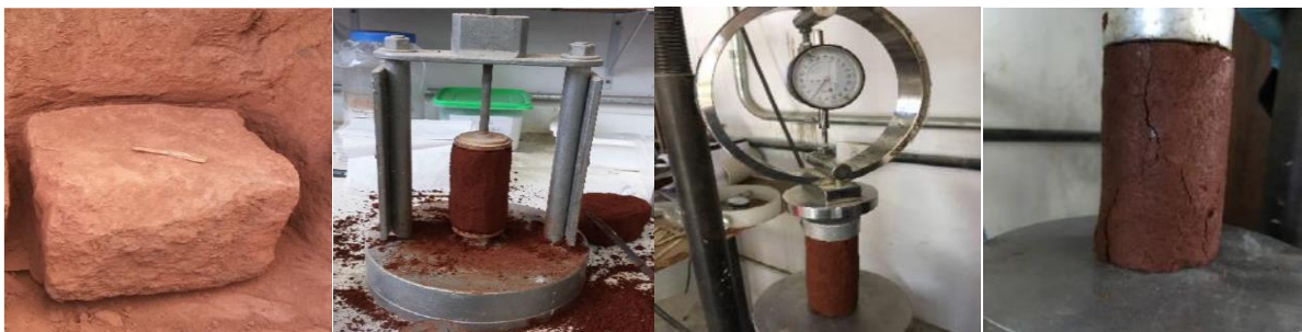
Figura 61 – Ensaio de compressão simples (a) bloco retirado (b) processo de esculpir (c) fase de carregamento do ensaio (d) banda de cisalhamento (CARRETTA, 2018)
