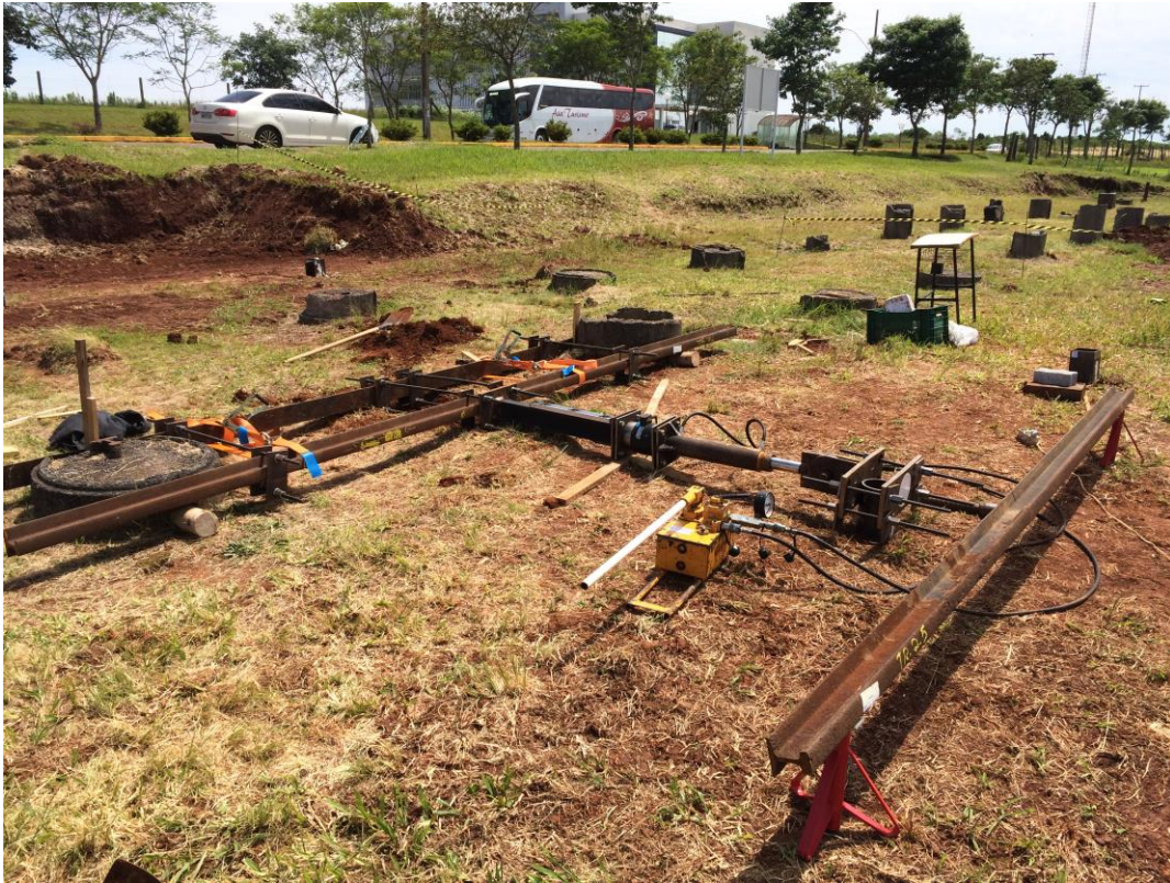
Figura 43 – Sistema do ensaio de prova de carga
