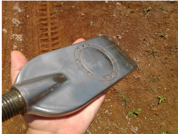
Figura 72 – Dilatômetro Padrão ASTM D6635-15 (2015). Imagem em Faro (2014)
