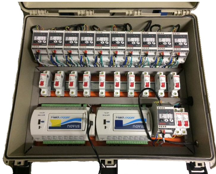
Figura 44 – Sistema de aquisição de dados
