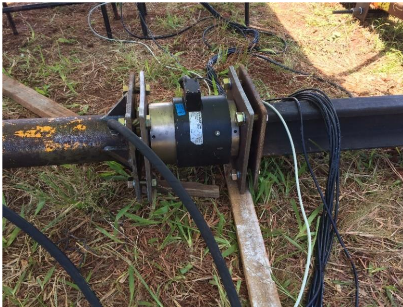
Figura 46 – Ligação entre estronca, célula de carga e cilindro hidráulico
