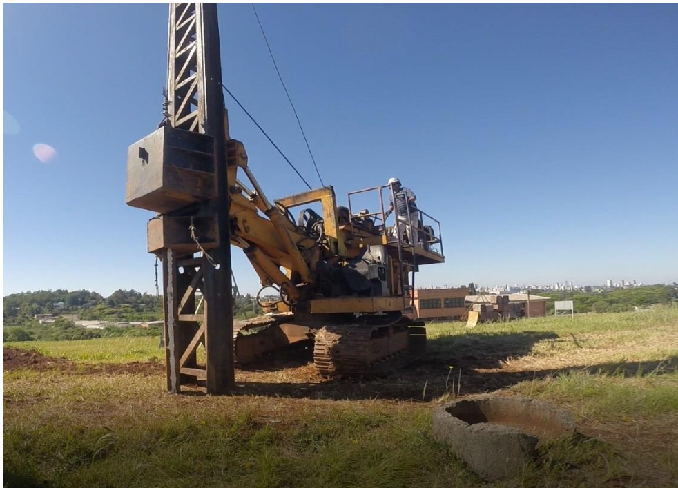
Figura 38 – Equipamento de bate-estaca
