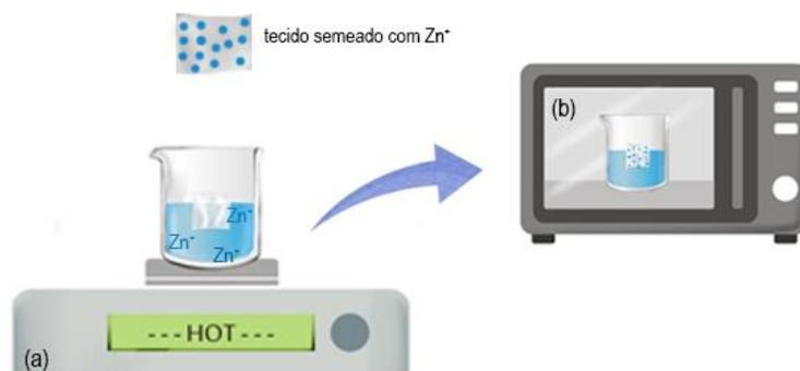
**Figura 31** – Ilustração esquemática da síntese *in-situ* via micro-ondas, método desenvolvido pelos pesquisadores da Universidade de Ulsan (a) solução de sementeação com íons de Zn (b) aquecimento da solução - energia para o processo de síntese de ZnO (Fonte : adaptado de V.H. Tran Thi, B.-K. Lee [80])
