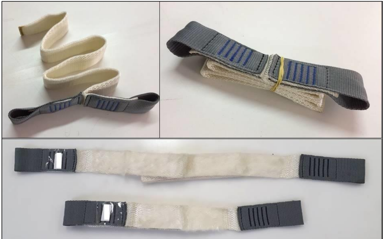
Figura 3.3 – Foto dos absorvedores de energia, na parte superior os equipamentos intactos e abaixo estão os que foram ensaiados em queda.
