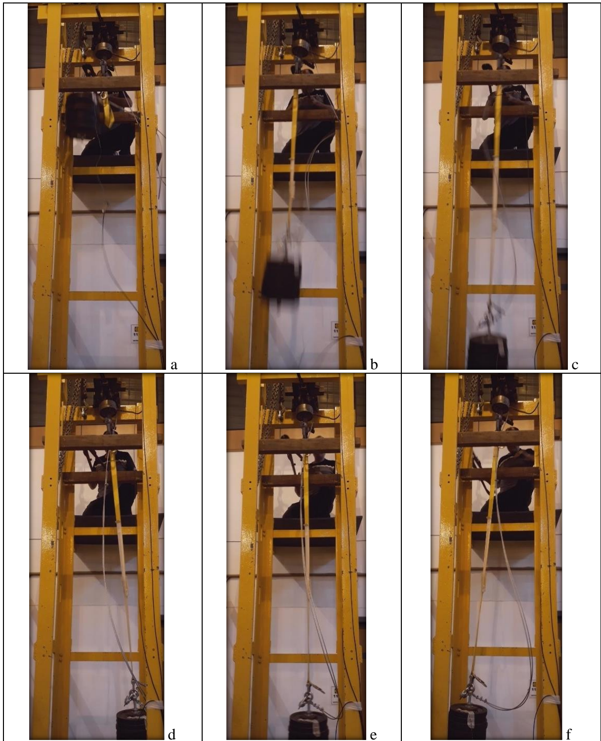
Figura B.1 – Fotos dos estágios do ensaio de queda.
