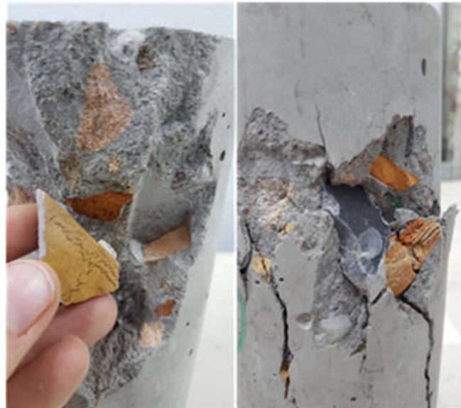
Figura 36 – Detalhes de ruptura de corpos de prova após o ensaio de resistência à compressão axial
