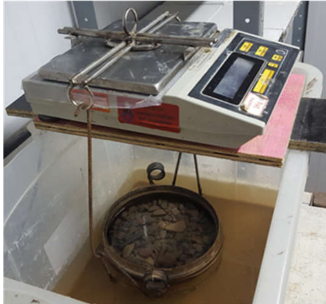
Figura 26 – Equipamentos e aparatos utilizados para o ensaio de absorção dos agregados reciclados
