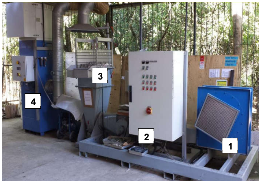
Figura 11 – Modelo jigue de escala piloto modelo AllAir® S-500
