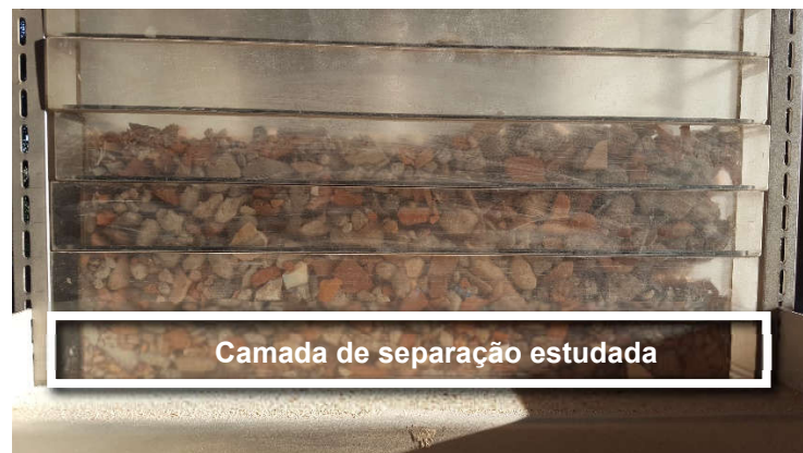
Figura 13 – Imagem da câmara de separação destacando a camada ou gaveta inferior, utilizada
