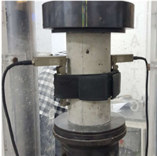
Figura 28 – Ensaio de módulo de elasticidade sendo realizado com extensômetro elétrico
