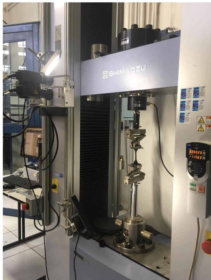
Figura 6.1. Ensaio de tração uniaxial realizado.
