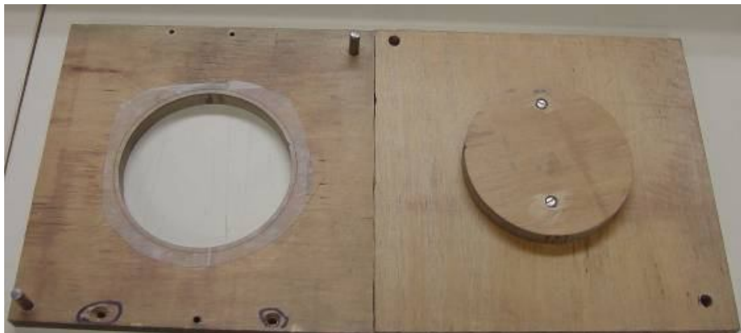
Figura 11: Ferramental para fazer as dobras das amostras de bandeja.
