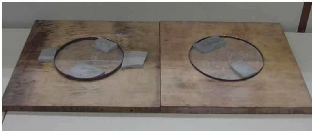
Figura 10: Ferramental de corte das amostras de tampa e bandeja
