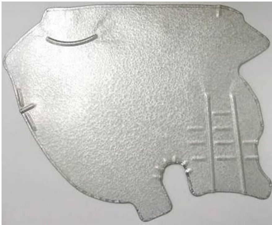
Figura 15: Conjunto de aço com revestimento de Zn55Al e isolante térmico.
