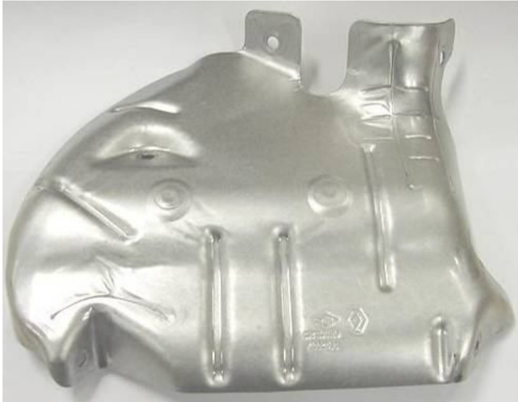
Figura 21: Peça conformada com aço revestido com AlSi
