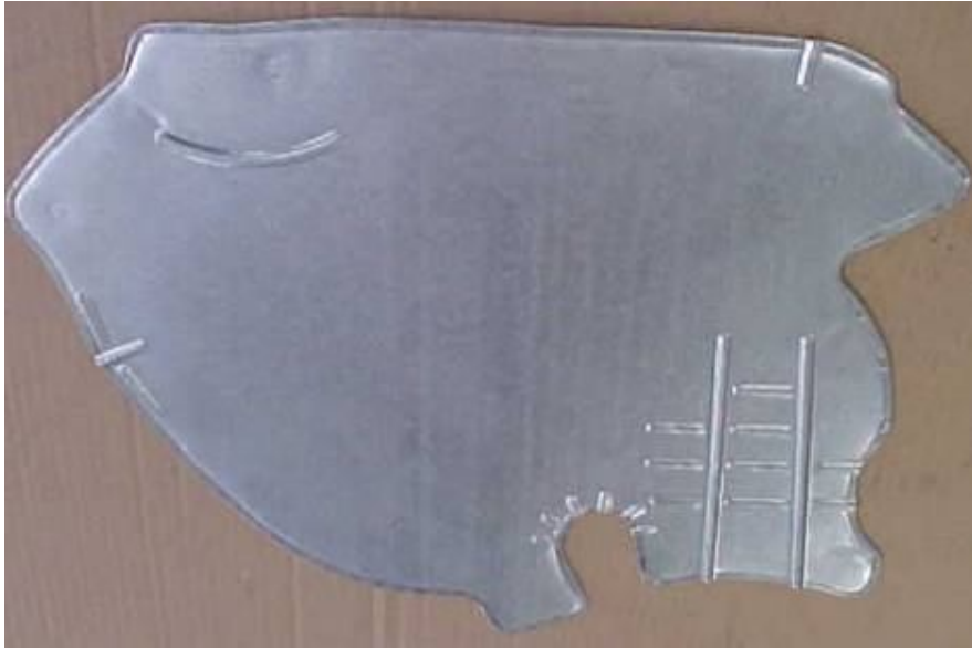
Figura 16: Conjunto de aço com revestimento de AlSi e isolante térmico.
