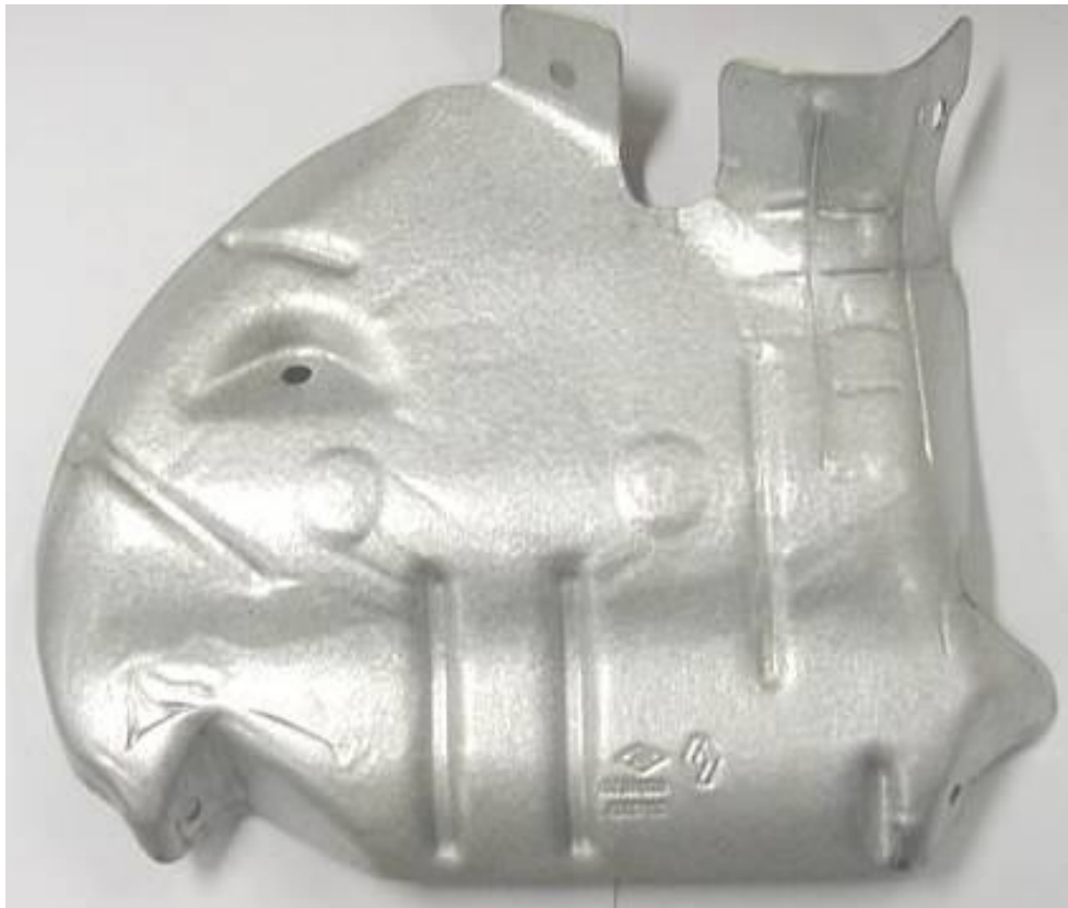
Figura 20: Peça conformada com aço revestido com Zn55Al.
