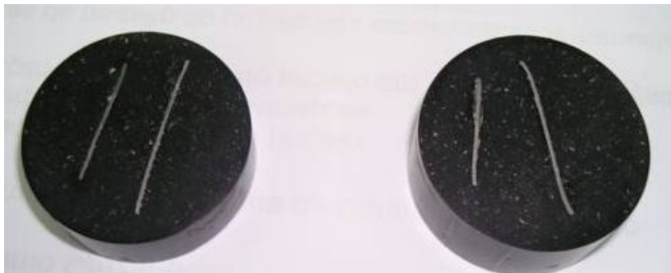
Figura 13: Corpos de prova embutidos para caracterização das camadas
