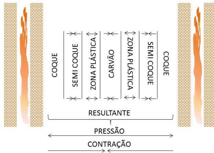
Figura 3 Forno de coqueificação esquemático com zonas de transformação de carvão em coque.
