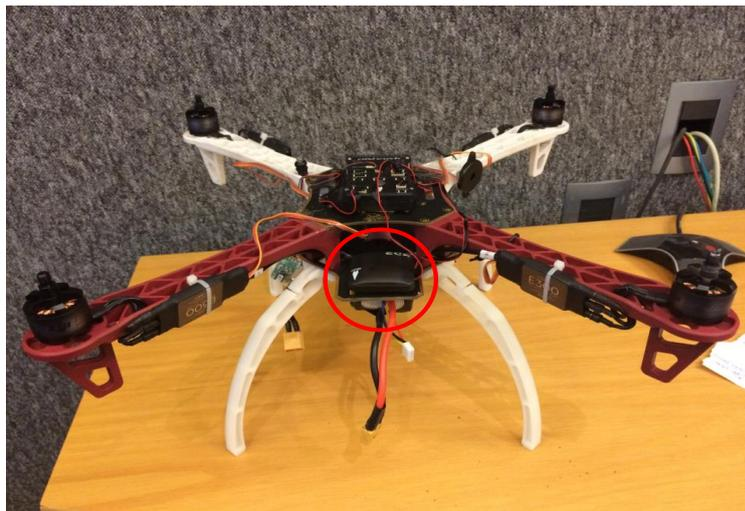
Figura 28. GPS instalado na frente da aeronave.
