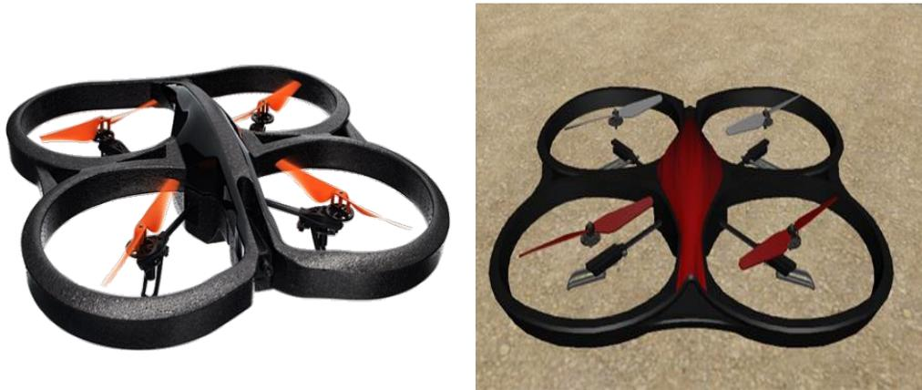
Figura 51. Foto real do equipamento (esquerda) e modelo 3D de drone implementado no simulador (direita).
