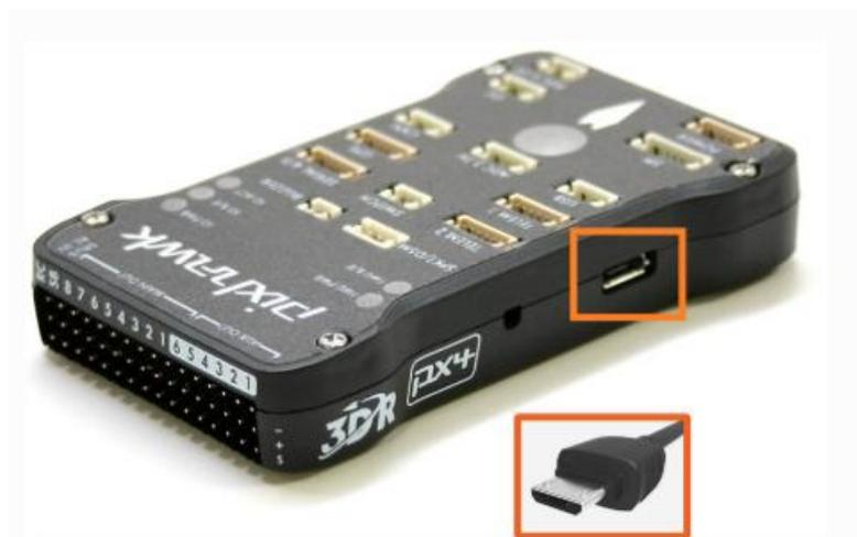
Figura 31. Entrada de conexão com computador via usb.
