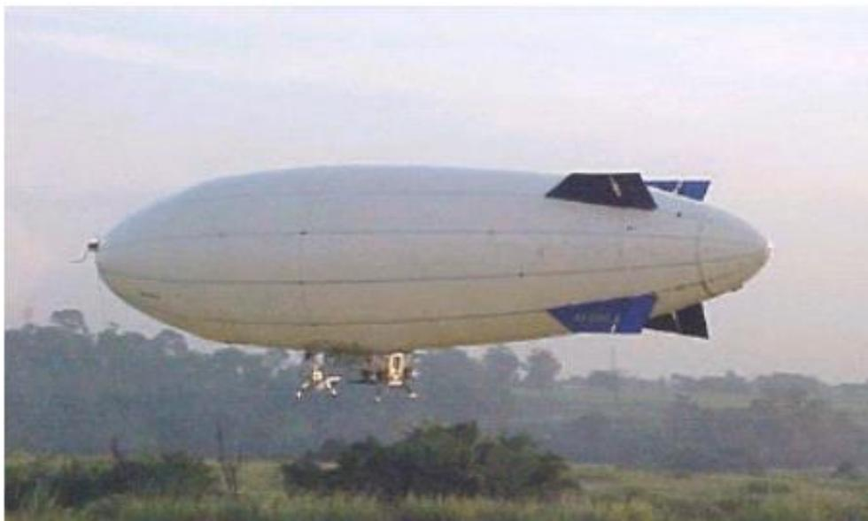
Figura 7. Dirigível Robótico Autônomo não tripulado para monitoração remota, CenPra.
