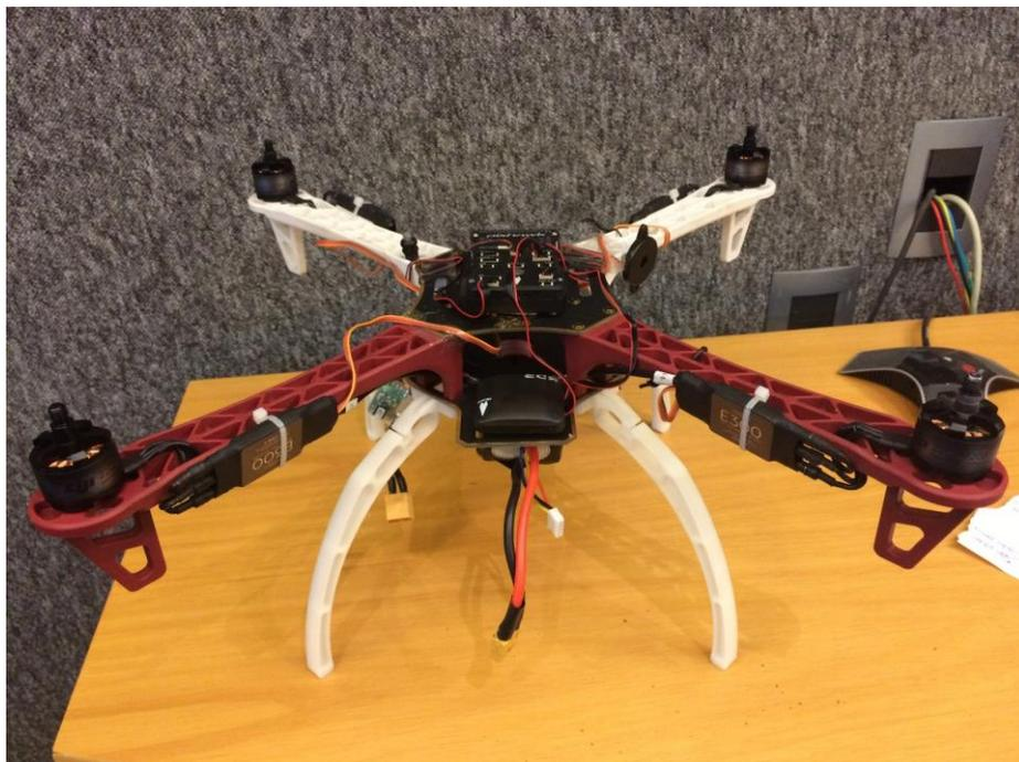
Figura 26. RPA após ser realizada a adição do *switch*, *buzzer* e *power module*.
