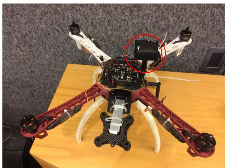
Figura 30. Nova posição e suporte do GPS.
