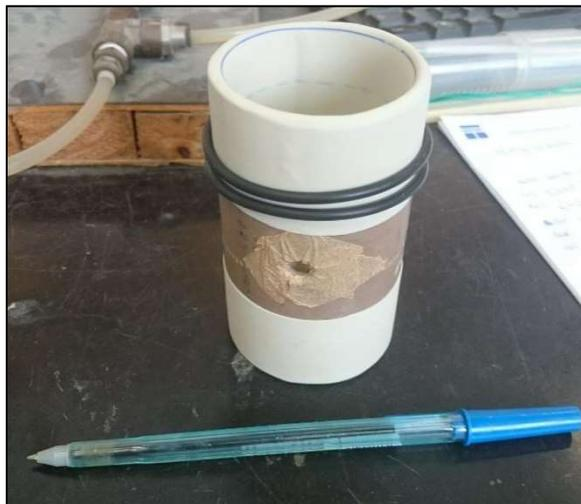
Figura 3.13 - Tubo de PVC auxiliar para preparação do corpo de prova indeformado para ensaios triaxiais
