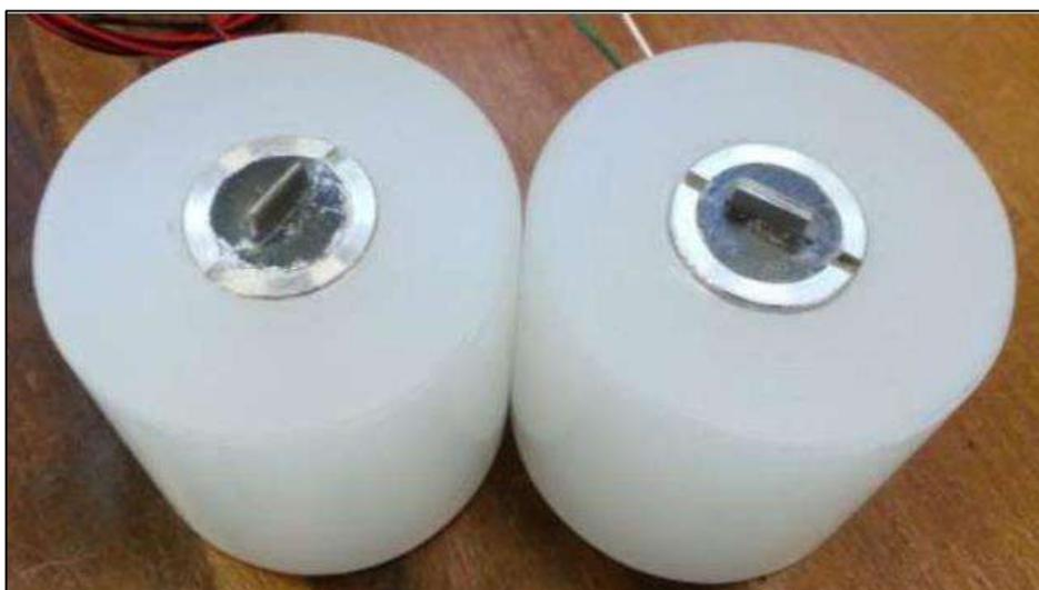
Figura 3.17 – *Bender elements* acoplados em pedestais de nylon para ensaios de bancada
