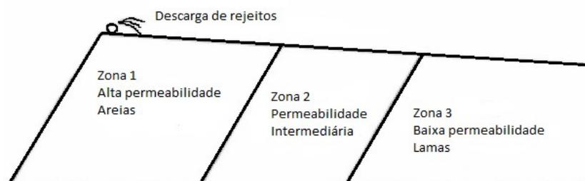
Figura 2.7 - Modelo conceitual de variação de permeabilidade dentro de depósitos de rejeitos (adaptado de Vick, 1983)
