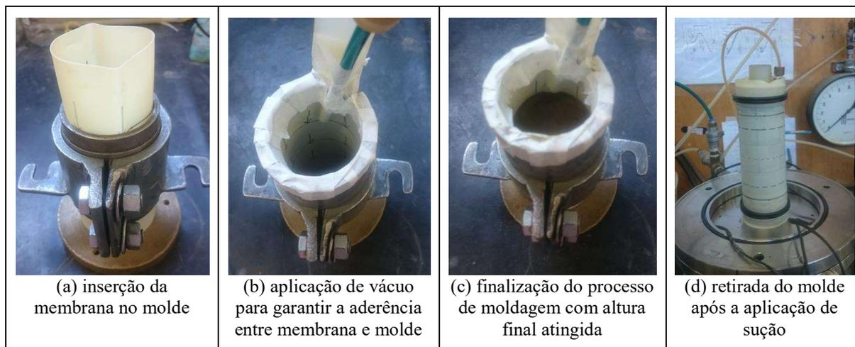
Figura 3.11 - Procedimentos de moldagem do corpo de prova para os ensaios triaxiais
