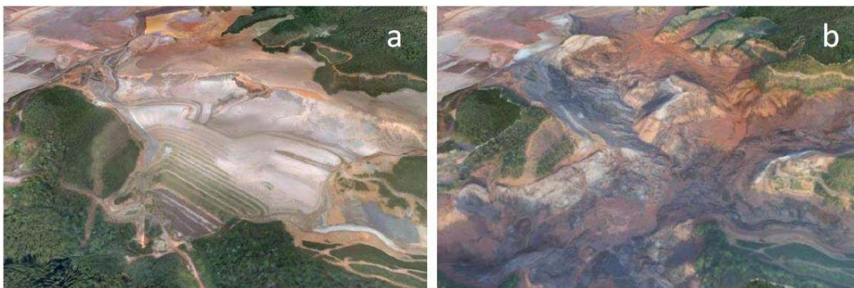
Figura 3.9 - Barragem de rejeitos de ferro de Fundão (a) antes da ruptura e (b) após a ruptura (Morgenstern *et al*, 2016)
