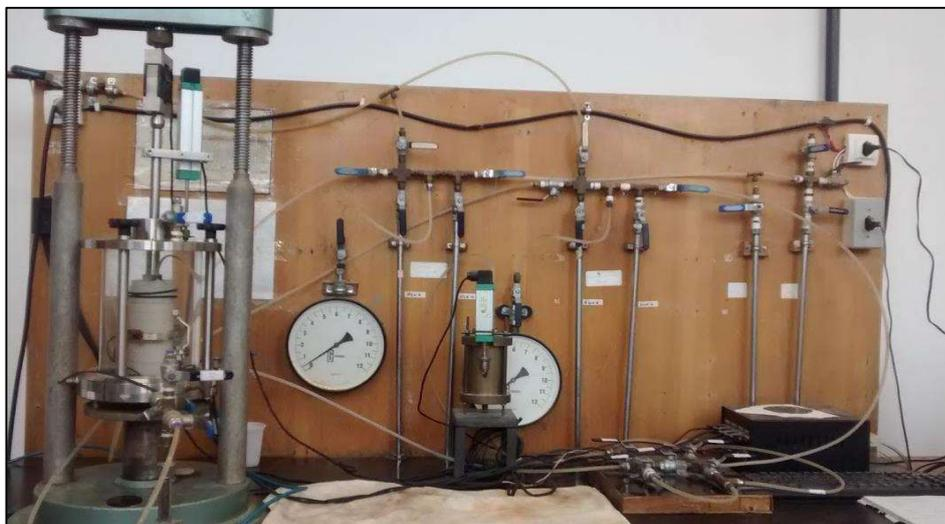
Figura 3.10 - Equipamento triaxial Geonor (LEGG)
