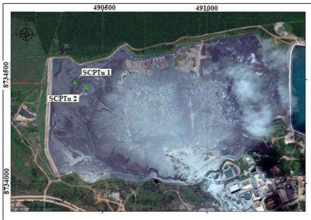
Figura 3.23 - Localização dos pontos de sondagem na barragem de rejeitos de mineração de ouro, campanha de 2012
