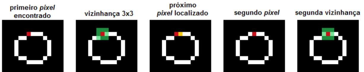
O processo deve ser repetido inúmeras vezes, enquanto os *pixels* não acabarem. Quanto ao trajeto que o algoritmo deve fazer, ele não pode retornar para o *pixel* de onde acabou de vir, isso implicaria em um *looping* sem fim. Conforme o algoritmo se desloca na borda da célula, ele deve calcular o tamanho do seu perímetro e a região máxima e mínima que a célula atinge nos eixos da imagem.
