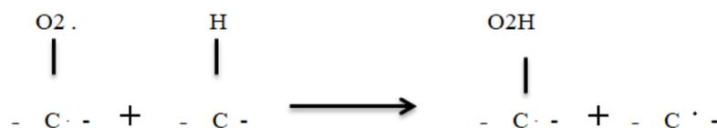
**C) TERMINAÇÃO** Ocorre quando os radicais C<sup>•</sup> (R<sup>•</sup>) e ROO<sup>•</sup> propagam-se até destruírem a si próprios.
