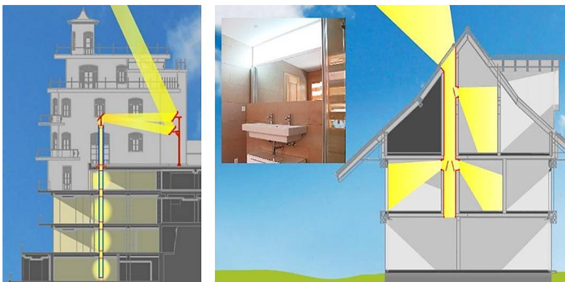
Figura 28 – Exemplos de SCCDLN utilizados em projetos da empresa Heliobus.
