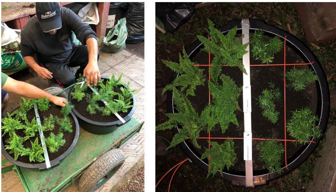
Figura 89 – Montagem dos vasos, posicionamento dos sensores e da grelha para auxiliar a avaliação do crescimento da vegetação.
