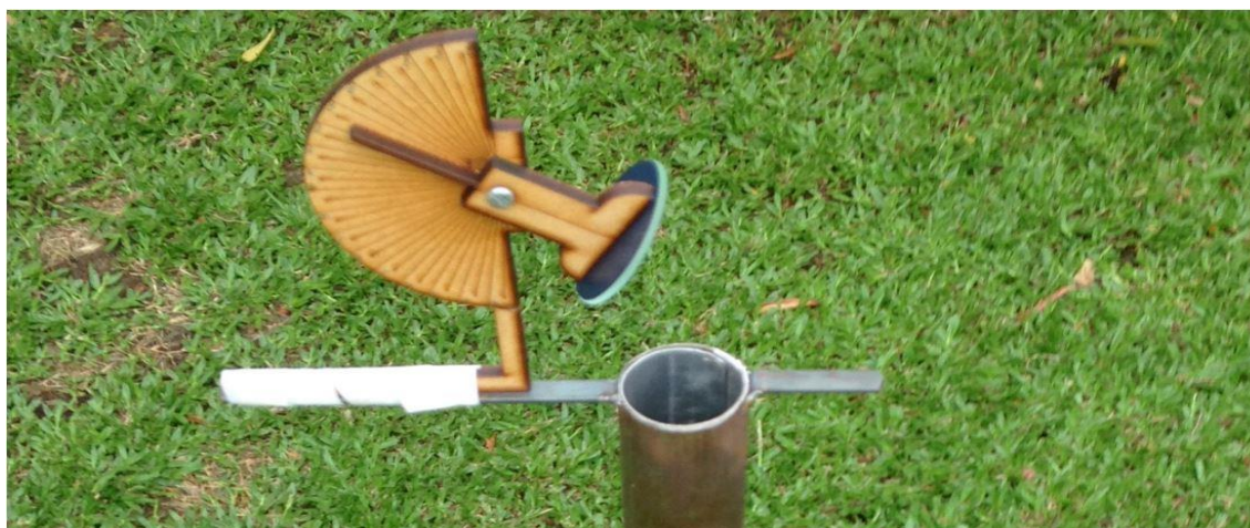
Figura 80 – Imagem do heliostato manual fixado no topo do duto de luz para realização dos testes de redirecionamento dos raios solares.
