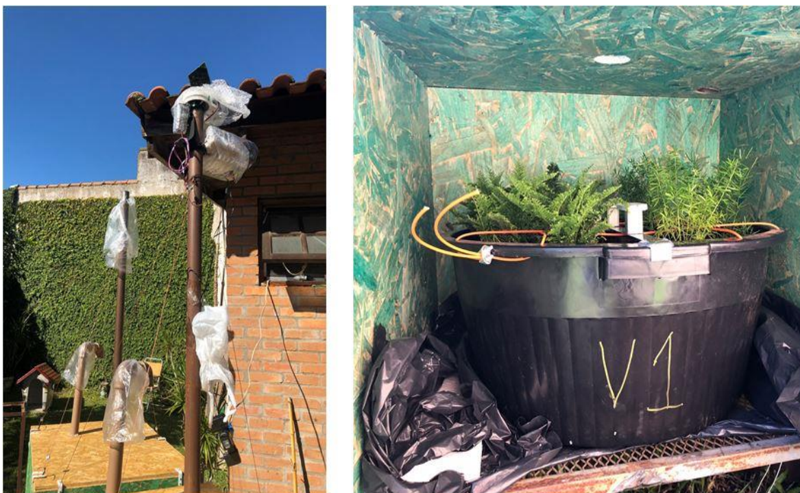
Figura 90 – Fase 3 do experimento: à esquerda, imagem dos dutos e do heliostato; à direita, o vaso no interior de uma das caixas.
