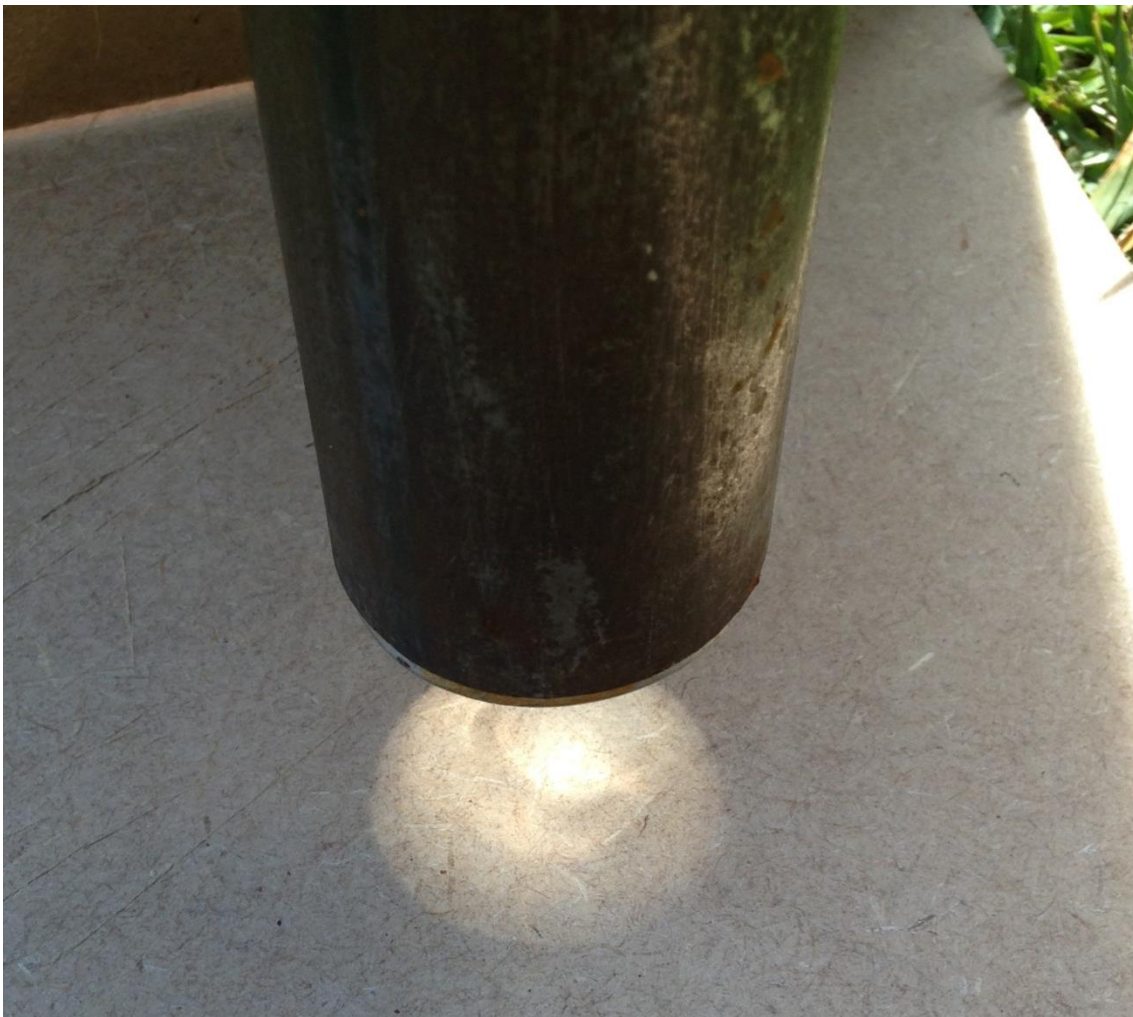
Figura 81 – Imagem dos raios solares, redirecionados pelo heliostato e conduzidos pelo duto de luz, iluminando a base de apoio dos cilindros metálicos.
