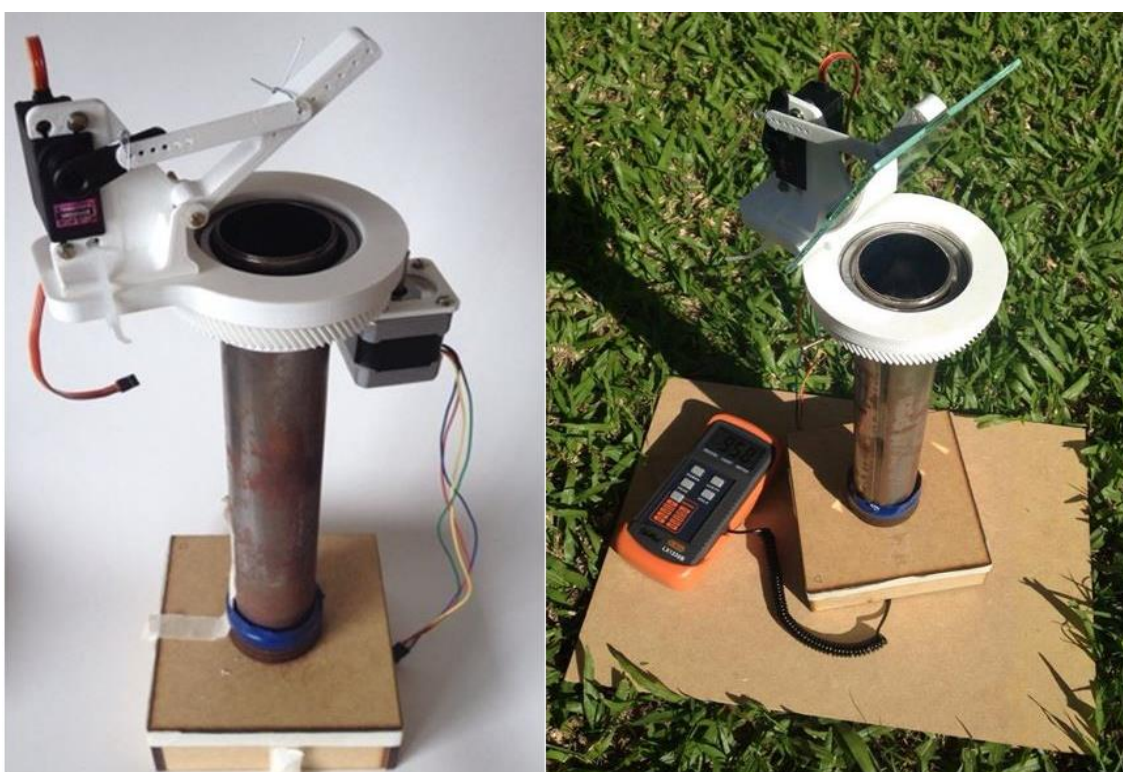
Figura 84 – Imagem da montagem do heliostato eletrônico (à esquerda) e dos primeiros testes manuais (à direita).
