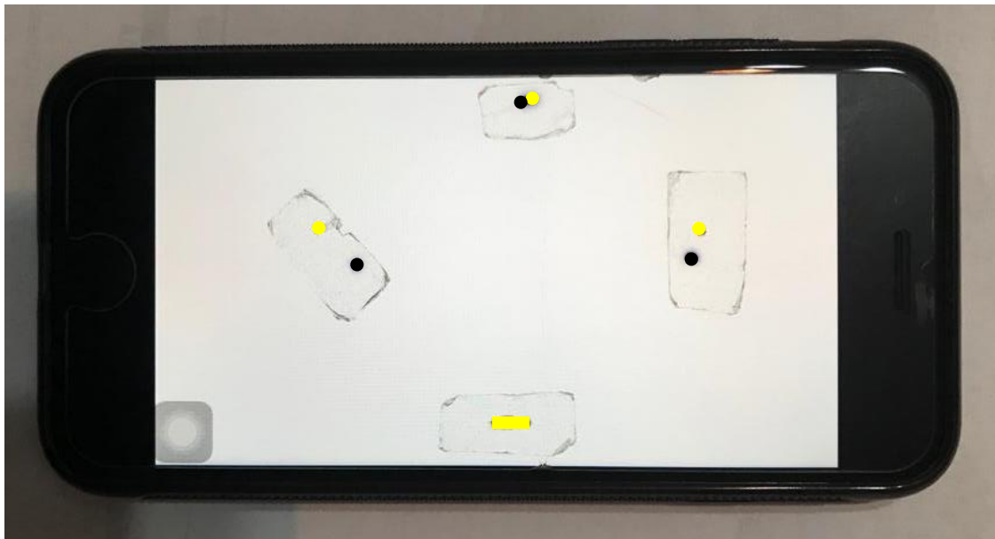
Figura 91 – Ilustração do telefone móvel com a marcação das posições dos vasos para a fotografia de perfil (pontos amarelos) e de cima (pontos pretos).
