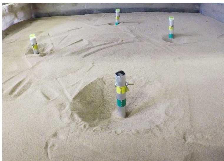
Figura E.6: configuração do conjunto solo-estaca após última fase de ciclos para a estaca E1.
