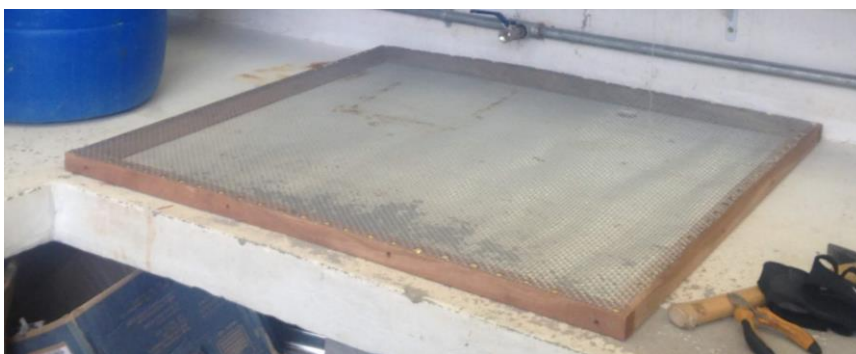
Figura 5.5: montagem de tela para homogeneidade da queda de grãos no processo de pluviação. Tela de 5mm com moldura em madeira.
