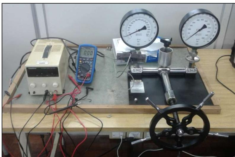
Figura F.1 – Montagem para levantamento da curva de calibração do transdutor Kulite.
