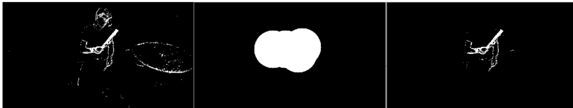
Figura 5.3: Aplicação da subtração de background com máscara de pose estimation
