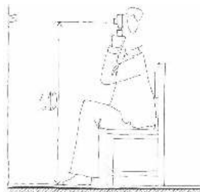
FIGURA 6.14 - Posicionamento do luminancímetro para medições de luminâncias
