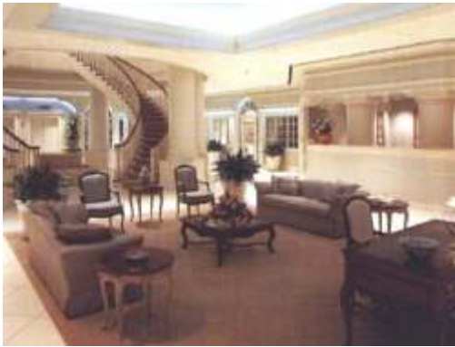
FIGURA 4.16 - Iluminação indireta, embutida em forro de gesso, na área de estar do Hospital Elmwood. Fonte: MALKIN, 1991.
