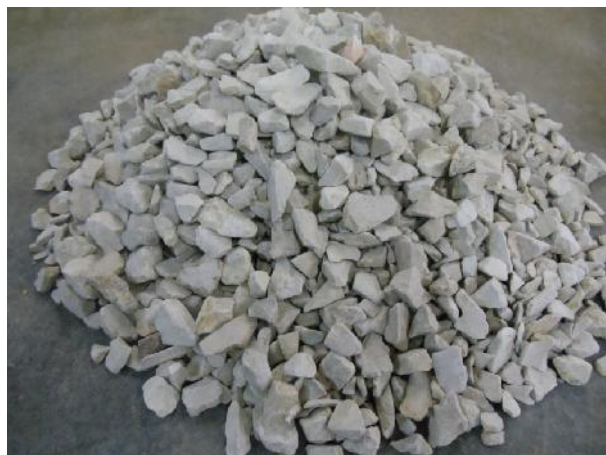
Figura 3.7 - Amostra de brita calcária usada no estudo (Laboratório de Materiais do IFRN)
