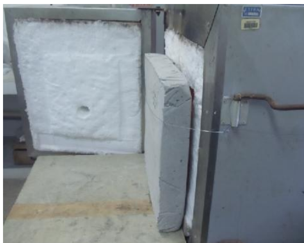
Figura 3.30 - Placa de concreto colocada com uma das faces exposta a altas temperatura
