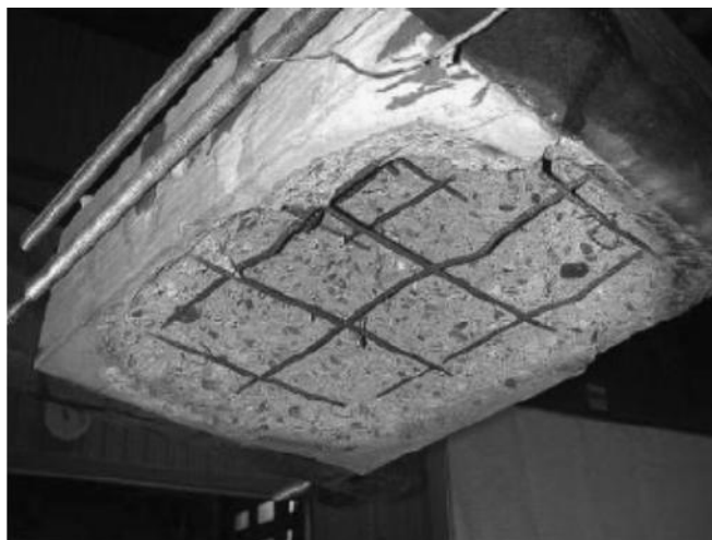
Figura 2.27 - Laje de concreto de pequenas dimensões após exposição à ação térmica em umas das faces (Boström et al. (2007))
