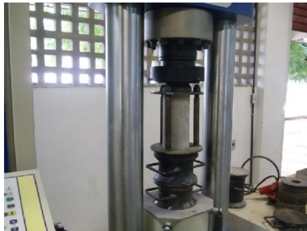
Figura 3.21 - Desenho esquemático do dispositivo de aplicação de carga (Laboratório de Materiais do IFRN)
