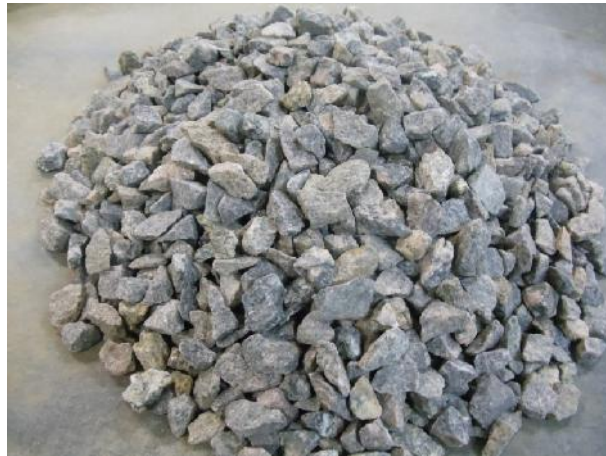
Figura 3.6 - Amostra de brita granítica usada no estudo (Laboratório de Materiais do IFRN)
