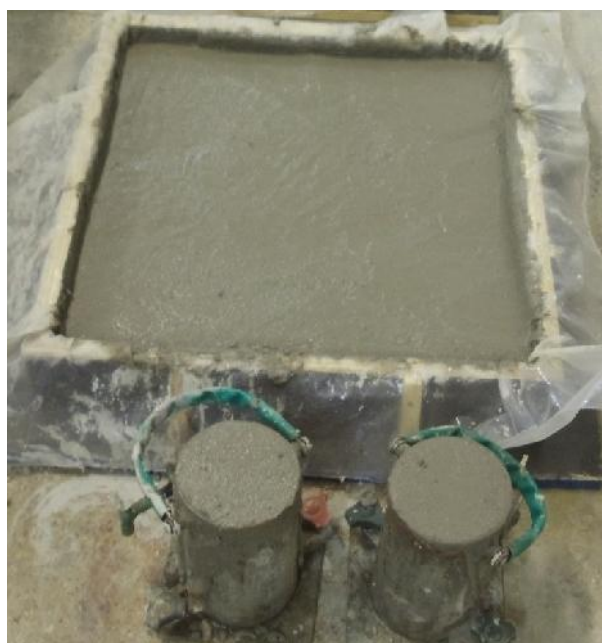
Figura 3.29 - Placa de concreto após a moldagem
