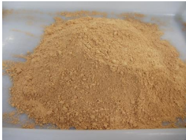
Figura 3.11 - Amostra do metacaulim usado no trabalho (Laboratório de Materiais do IFRN)
