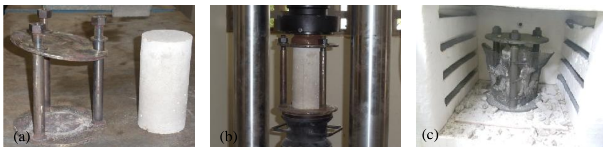
Figura 3.25 - Procedimentos experimentais: a) Dispositivo de carga e corpo-de-prova; b) Máquina de ensaio com dispositivo de carga e disco de transmissão; c) Dispositivo de carga com corpo-de-prova no interior do forno após exposição térmica
