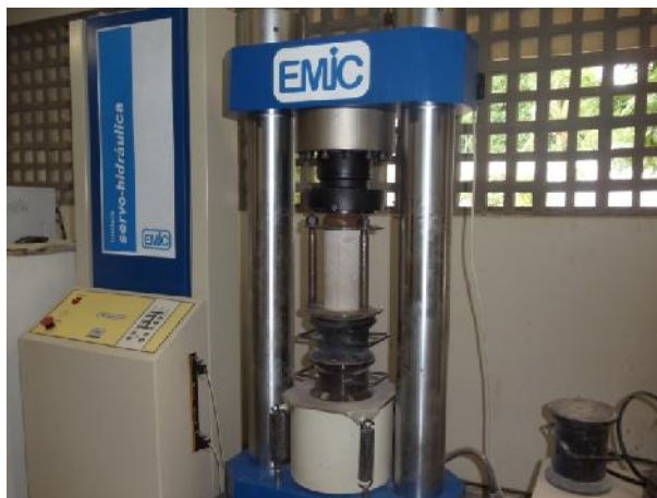
Figura 3.22 - Máquina de ensaio para determinação da resistência à compressão (Laboratório de Materiais do IFRN)
