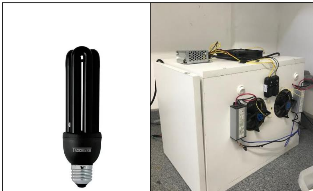
Figura 14. Lâmpada e fotoreator utilizados nas reações fotoinduzidas.
