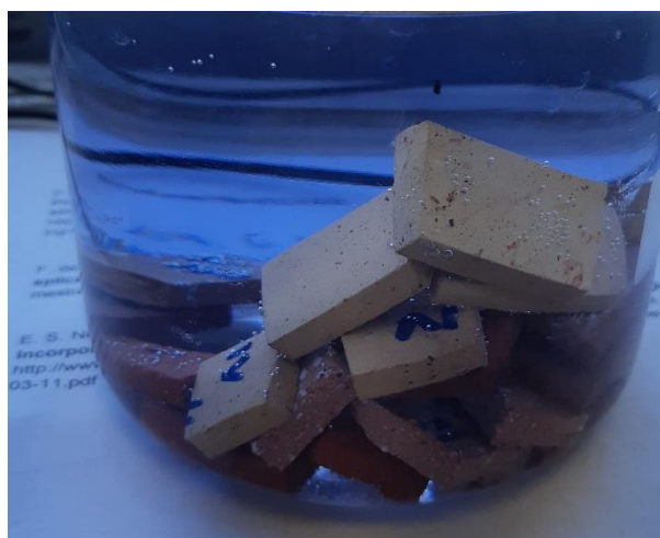
Figura 75: Corpos de prova submersos em água há 24h
