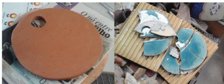
Figura 38: protótipos das tábuas em secagem e quebrado pós queima
