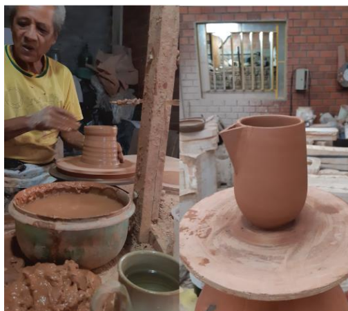
Figura 36: Produção no novo protótipo de jarra do conjunto moderno pelo oleiro Renato
