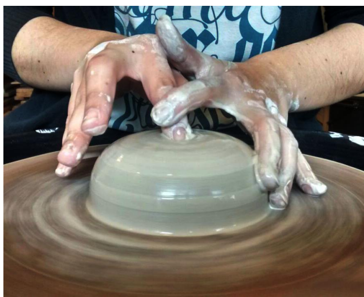
Figura 15: Abertura do buraco central no torno
