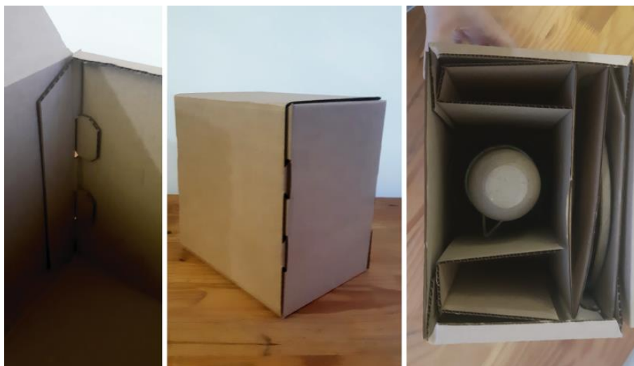
Figura 55: Protótipo final da embalagem e suas proteções internas
