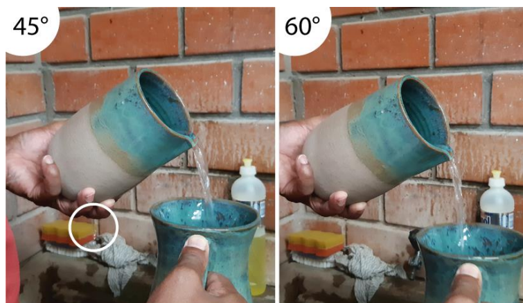
Figura 42: Ângulos de escoamento do protótipo de bico inicial
