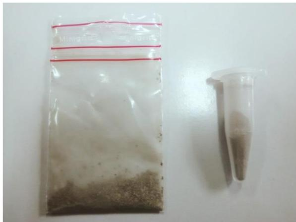
Figura 12 - Material após fracionamento granulométrico. À esquerda fração inferior a 10  $\mu\text{M}$  , à direita superior.
