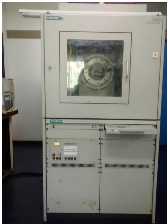
Figura 14 - Difratômetro de raios X, pertencente ao CPGq do IGEO-UFRGS.
