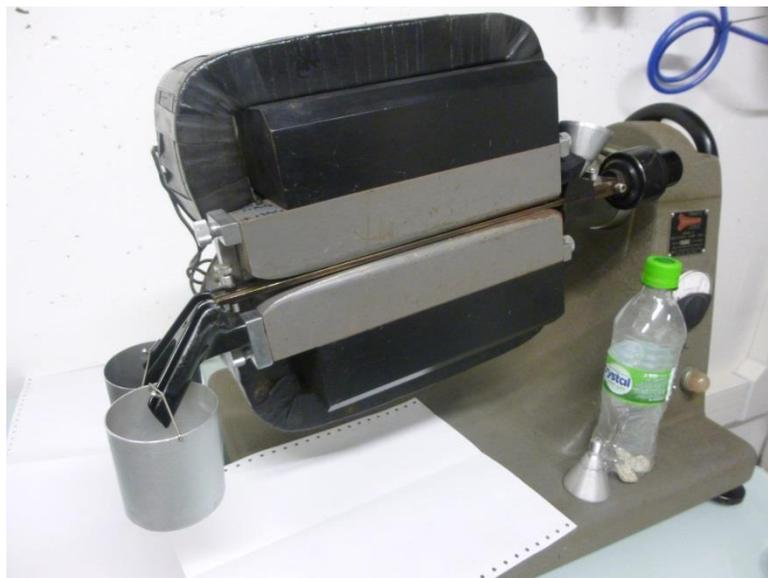
Figura 13 - Separador magnético isodinâmico Frantz.
