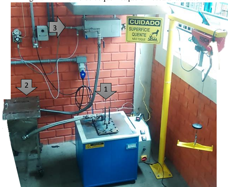
(1) Forno de coqueificação, (2) Condensador de alcatrão, (3) Queimador de gases.
