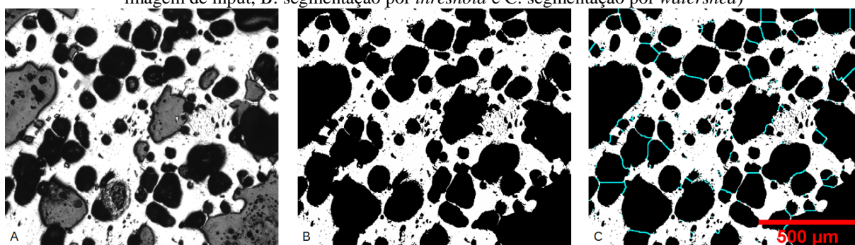
Figura 4.7 – Sequência de etapas de segmentação prévias a obtenção dos parâmetros microestruturais (A: imagem de input, B: segmentação por threshold e C: segmentação por watershed )
