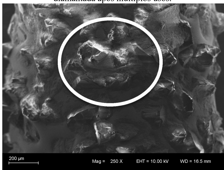
Figura 76 - Para ilustração, demonstra o emaranhado de debris presente na ponta diamantada após múltiplos usos.
