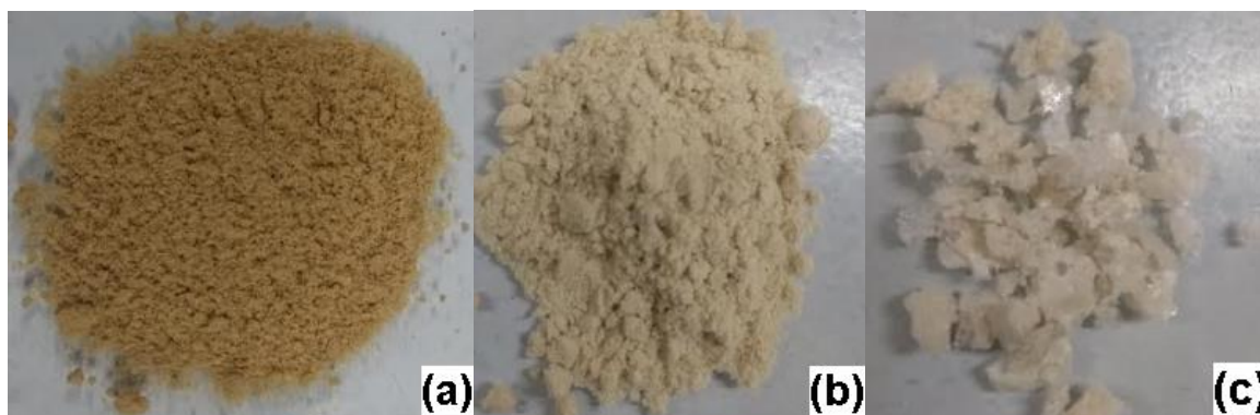
Figura 10 - Amostras após trituração. (a) extrato puro; (b) extrato + maltodextrina; (c) extrato + pectina.
