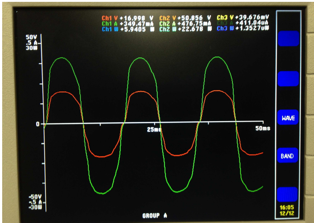
Figura 80 – Forma de onda ampliada da tensão de saída do inversor para tensão de entrada de 50V.
